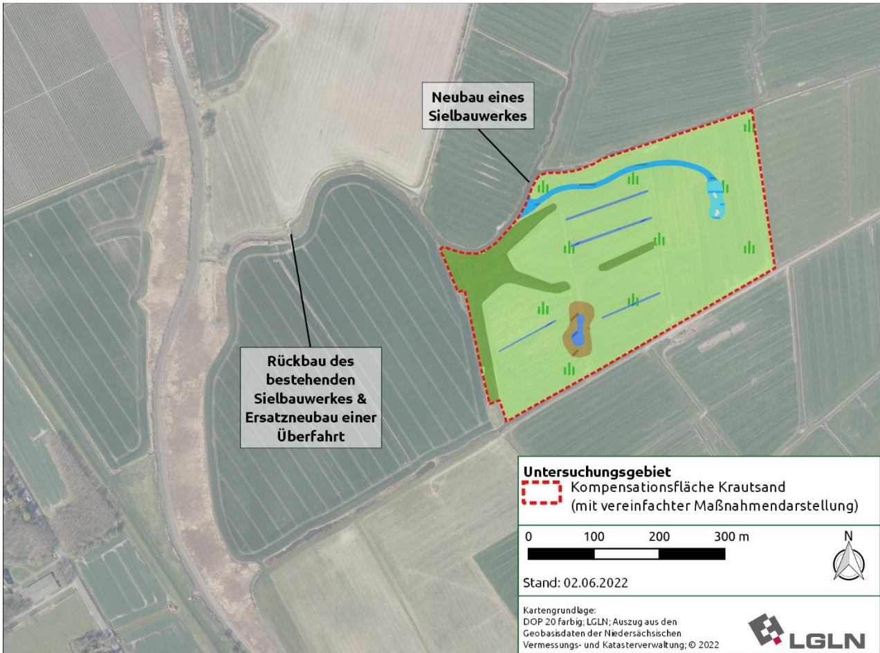
Abbildung 121: Verlegung des bestehenden Sielbauwerkes Südliches Sandloch
