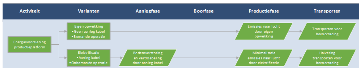
Abbildung 18: Konsequenzen der realistischen Varianten für die Energieversorgung der Produktionsplattform
