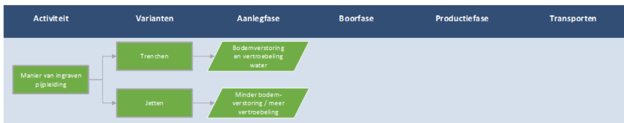
Abbildung 22: Konsequenzen der realistischen Varianten für die Verlegemethode der Pipeline
