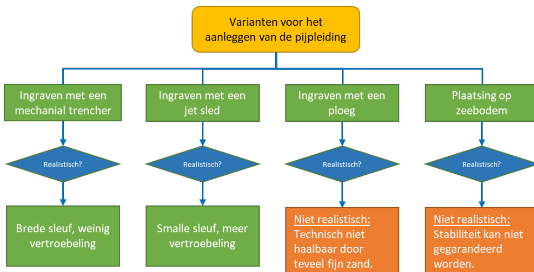
Abbildung 21: Varianten für die Verlegungsmethode der Rohrleitung
