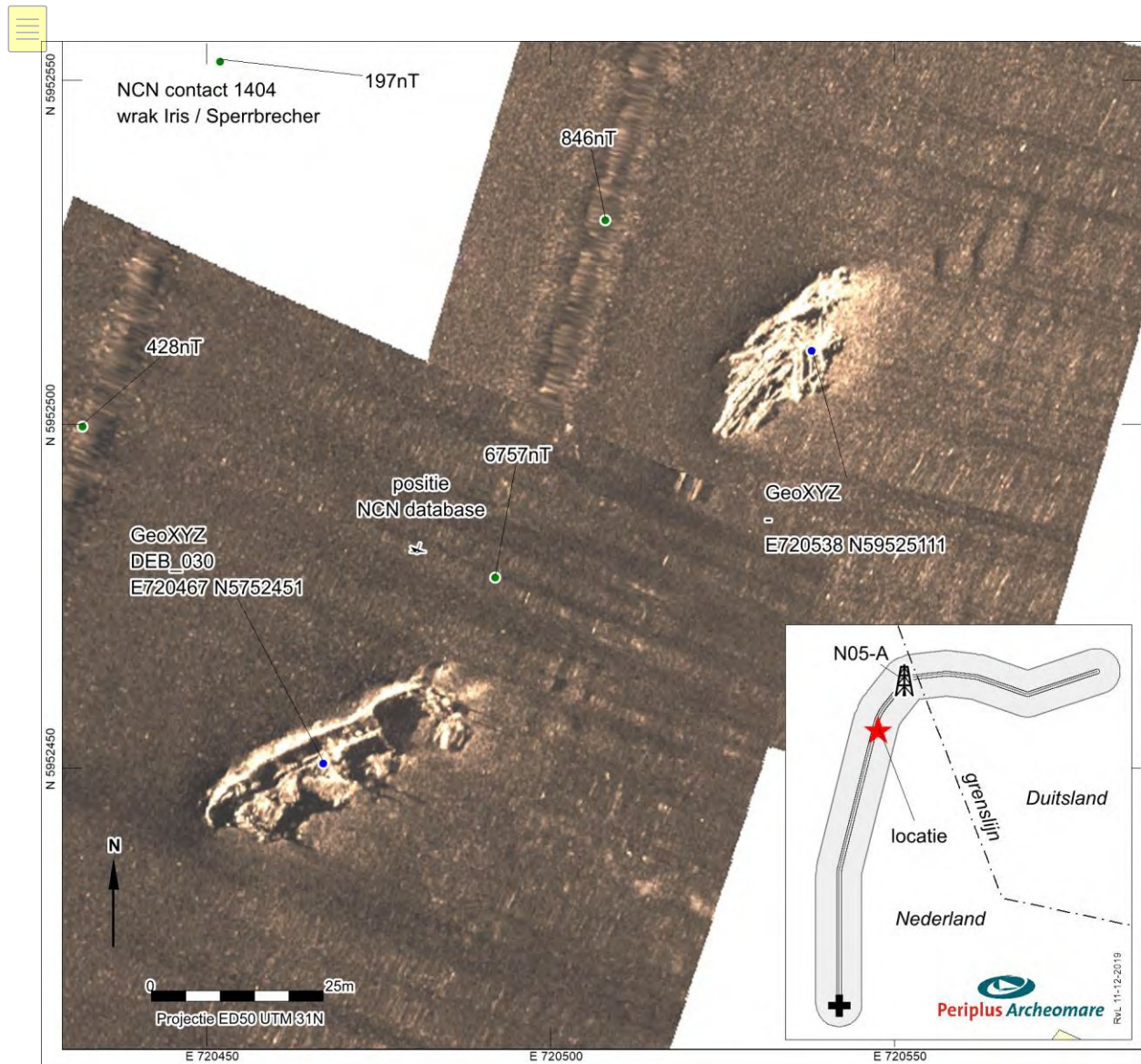
Abbildung 20: Seitensichtsonarbild des Wracks der Iris/Sperrbrecher (NCN1404, 1942).
