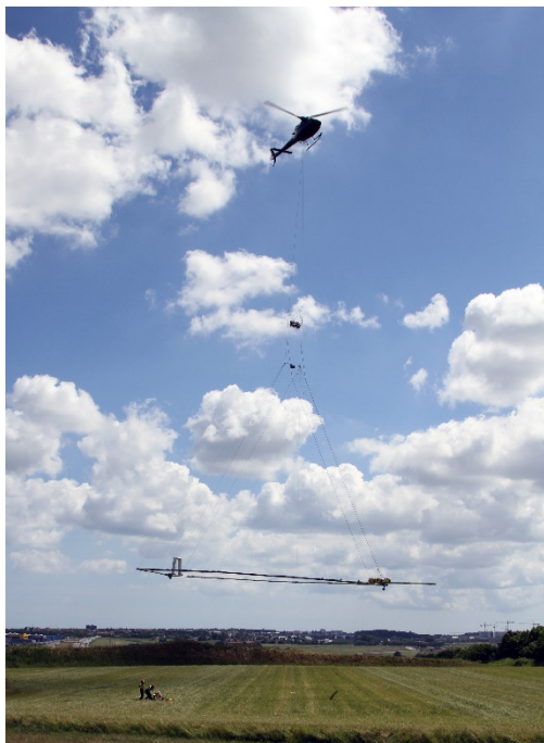
Abb. 5.5.3-2: Beispielfoto TEM-Befliegung, helikoptergestützt (Quelle: http://skytem.com/photos/ )
