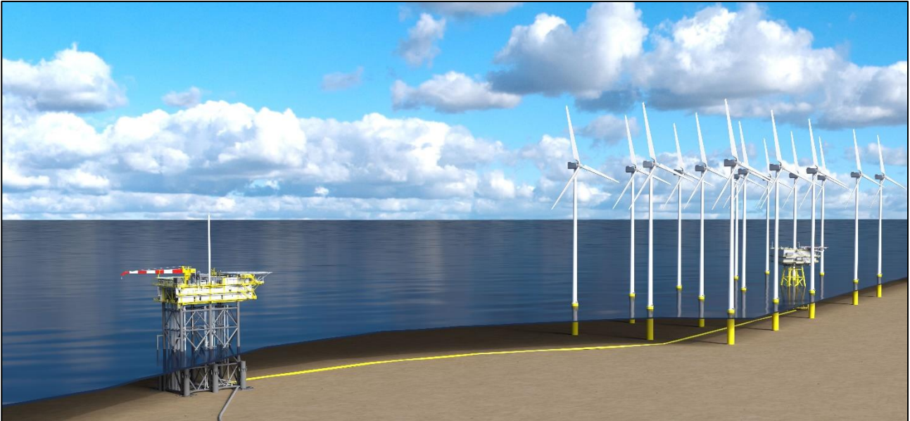
Abbildung 5: Geplante Produktionsplattform N05-A mit Anbindung an Offshore-Windpark Riffgat Quelle: ONE-Dyas, 11.01.2022 (E-Mail)
