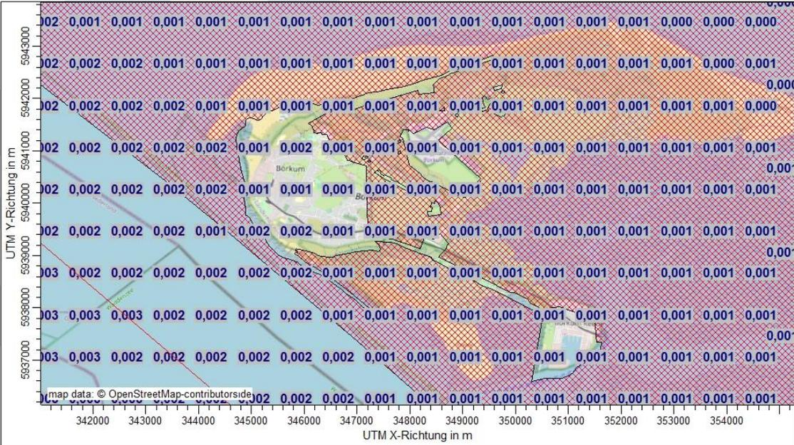
Abbildung 16. Projektspezifischen Zusatzbelastung (Jahresmittelwert) in den terrestrischen Ökosystemen der Insel Borkum durch die Deposition von **Stickstoff** und **Schwefel** in **Säureäquivalenten** keq (N+S) / (ha × a) im Szenario „Jahr 2“. Abschneidekriterium: 0,04 keq (N+S) / (ha × a).
