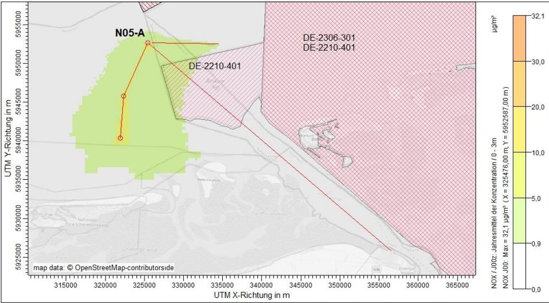
Abbildung 9. Projektspezifische Zusatzbelastung (Jahresmittelwerte) für **NO<sub>x</sub>** in µg/m<sup>3</sup> („Jahr 2“) im Rechengebiet (Zusatzbelastungen bis zum Bagatellkriterium von ≤ 3 % des Critical Level sind transparent dargestellt).
