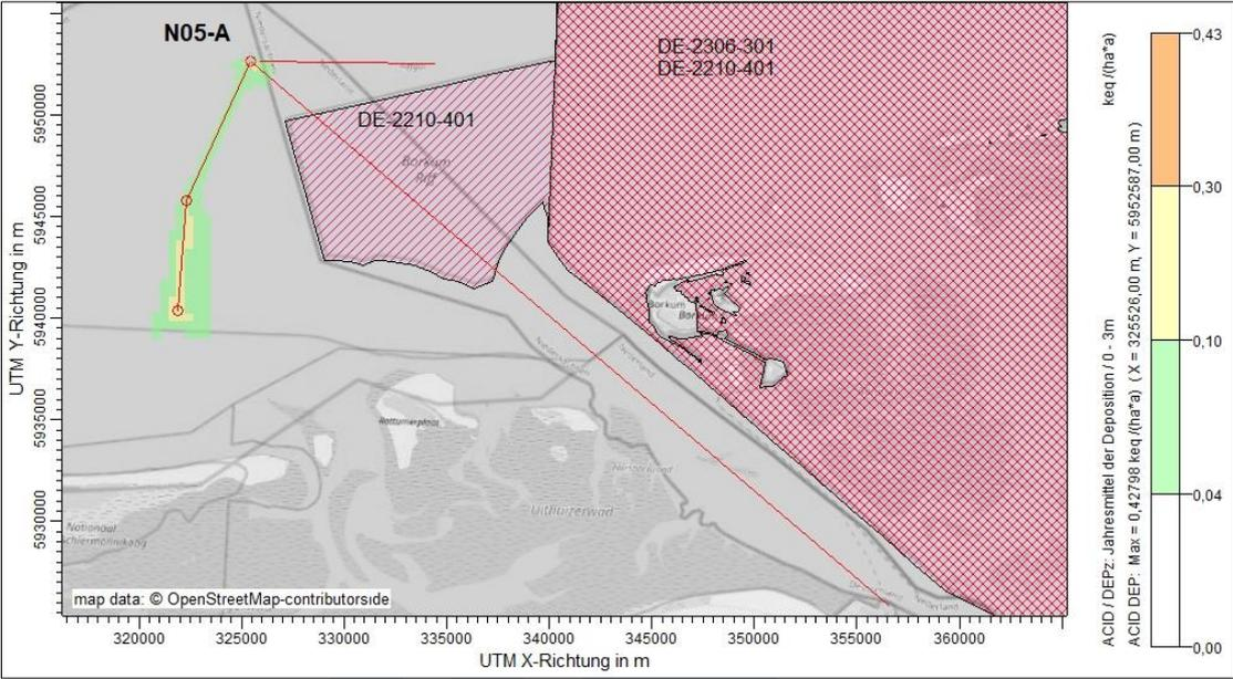
Abbildung 15. Räumliche Verteilung der projektspezifischen Zusatzbelastung (Jahresmittelwert) im Rechengebiet durch Deposition von **Stickstoff** und **Schwefel** in **Säureäquivalenten** keq (N+S)/(ha×a) im Szenario „Jahr 2“. Abschneidekriterium: 0,04 keq (N+S)/(ha×a).
