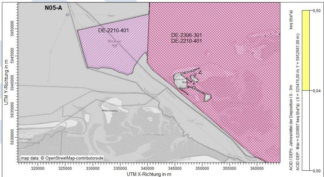
Abbildung 19. Räumliche Verteilung der projektspezifischen Zusatzbelastung (Jahresmittelwert) im Rechengebiet durch Deposition von **Stickstoff** und **Schwefel** in **Säureäquivalenten** keq (N+S) / (ha × a) im Szenario „Jahr 3“. Abschneidekriterium: 0,04 keq (N+S) / (ha × a).
