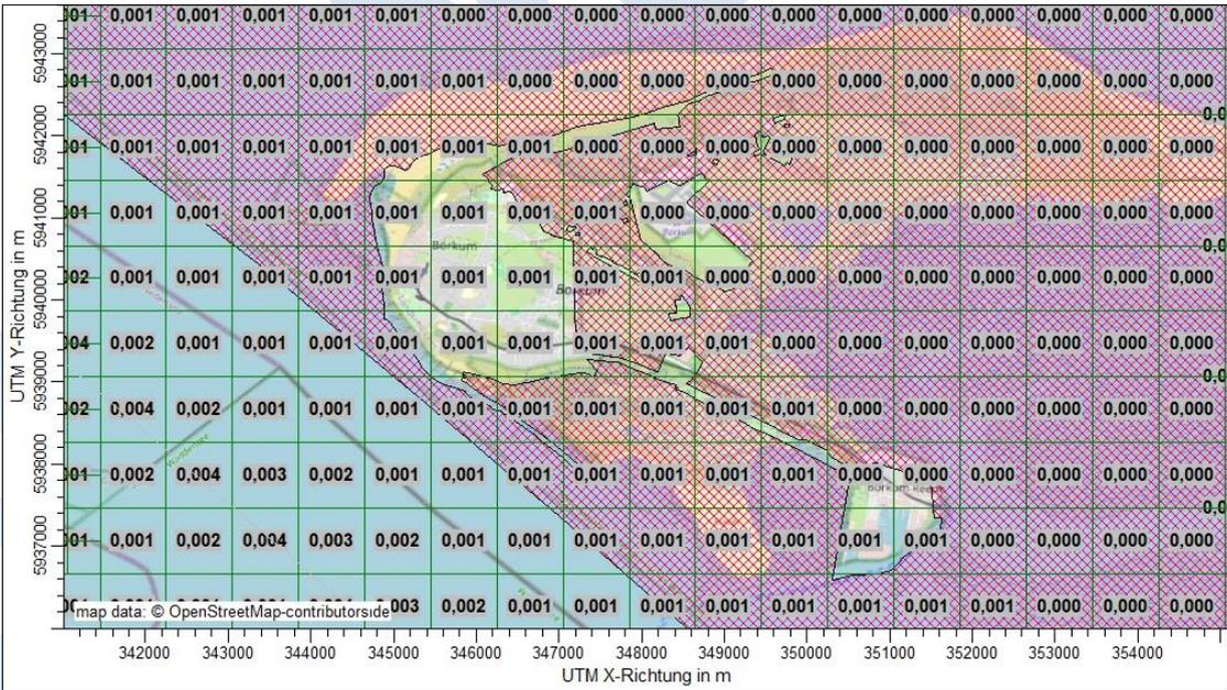
Abbildung 18. Projektspezifische Zusatzbelastung (Jahresmittelwert) in den terrestrischen Ökosystemen bei Borkum durch die Deposition von eutrophierenden **Stickstoffverbindungen** (in kg N / (ha x a)) im Szenario „Jahr 3“. Abschneidekriterium: 0,3 kg N / (ha x a).
