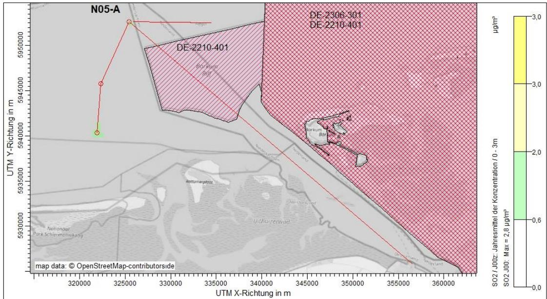
Abbildung 11. Projektspezifische Zusatzbelastung (Jahresmittelwerte) für **SO<sub>2</sub>** in µg/m<sup>3</sup> („Jahr 2“) in terrestrischen Ökosystemen von Borkum (Zusatzbelastungen bis zum Bagatellkriterium von ≤ 3 % des Critical Level sind transparent dargestellt).
