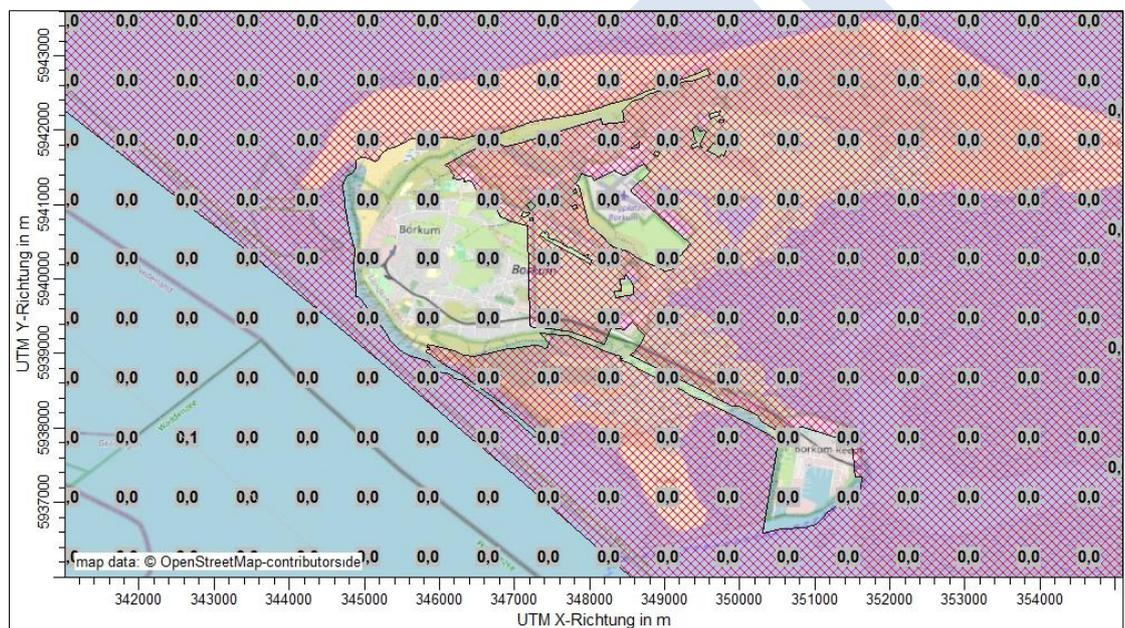
Abbildung 12. Projekt-spezifische Zusatzbelastung (Jahresmittelwerte) für  $\text{NO}_x$  in  $\mu\text{g}/\text{m}^3$  („Jahr 3“) im terrestrischen Bereich des Natura 2000-Gebietes.
