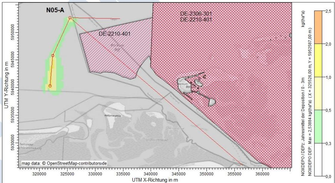
Abbildung 13. Räumliche Verteilung der projektspezifischen Zusatzbelastung (Jahresmittelwert) im Rechengebiet durch die Deposition von eutrophierenden **Stickstoffverbindungen** (in kg N / (ha × a)) im Szenario „Jahr 2“. Abschneidekriterium: 0,3 kg N / (ha × a).
