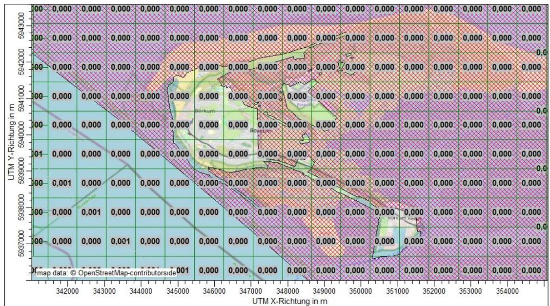
Abbildung 20. Projekt-spezifischen Zusatzbelastung (Jahresmittelwert) in den terrestrischen Ökosystemen der Insel Borkum durch die Deposition von **Stickstoff** und **Schwefel** in **Säureäquivalenten**  $\text{keq (N+S) / (ha \times a)}$  im Szenario „Jahr 3“. Abschneidekriterium:  $0,04 \text{ keq (N+S) / (ha \times a)}$ .
