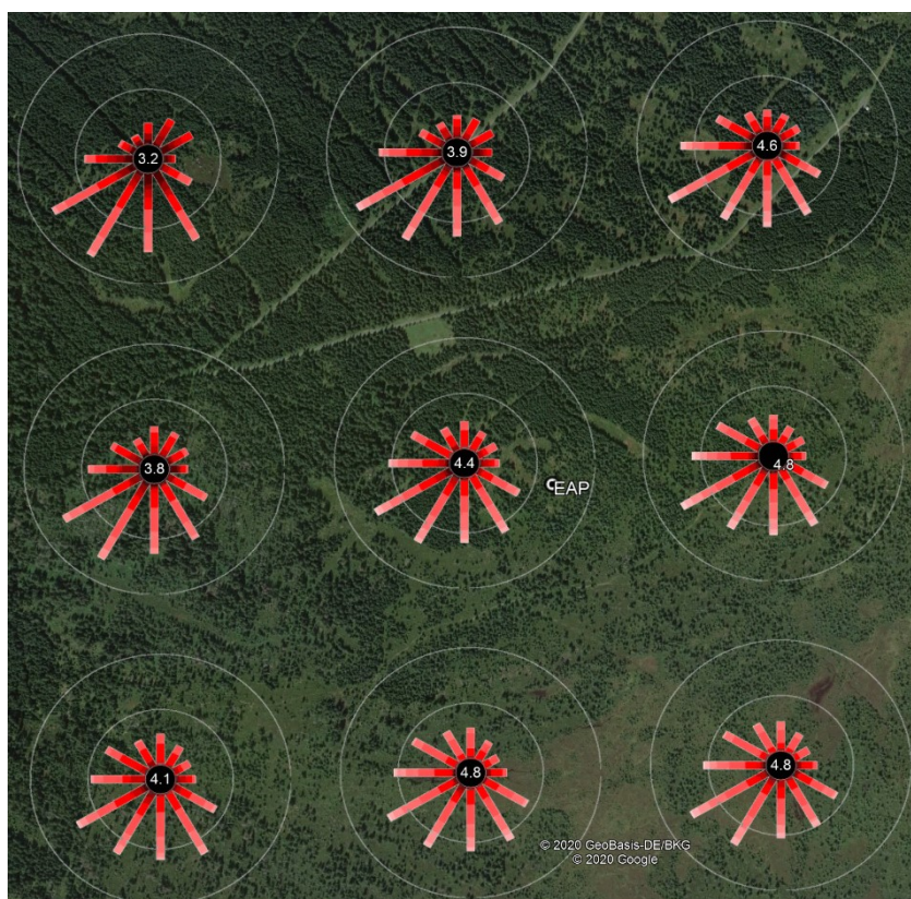
Abbildung 8.3: Synthetische Windrosen (SynWSGE) und Jahresmittel Windgeschwindigkeit im Bereich der EAP (© 2020 Google, Geobasis-DE/BKG).
