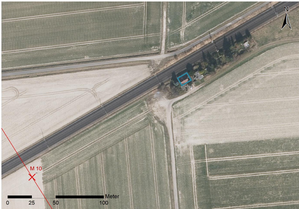
Abbildung 9: Leitungsachse mit Maststandort (rot) und Lage zu Wohngebäude im Außenbereich (gem. § 35 BauGB; türkis) im Bereich von M 10.
