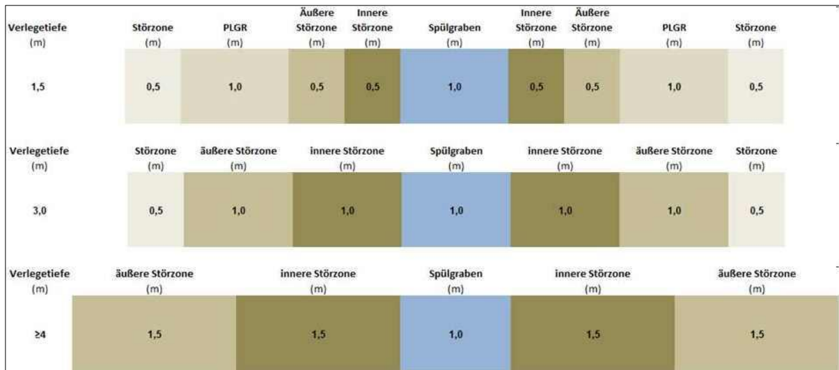
Abbildung 6-1: Verlegetiefenbezogene Eingriffsbreiten im Einspülverfahren
