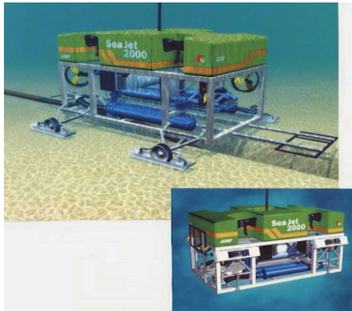
Abbildung 31: Unterwasser-Eingrabegeräte (TROV) (Quelle: OMM).
