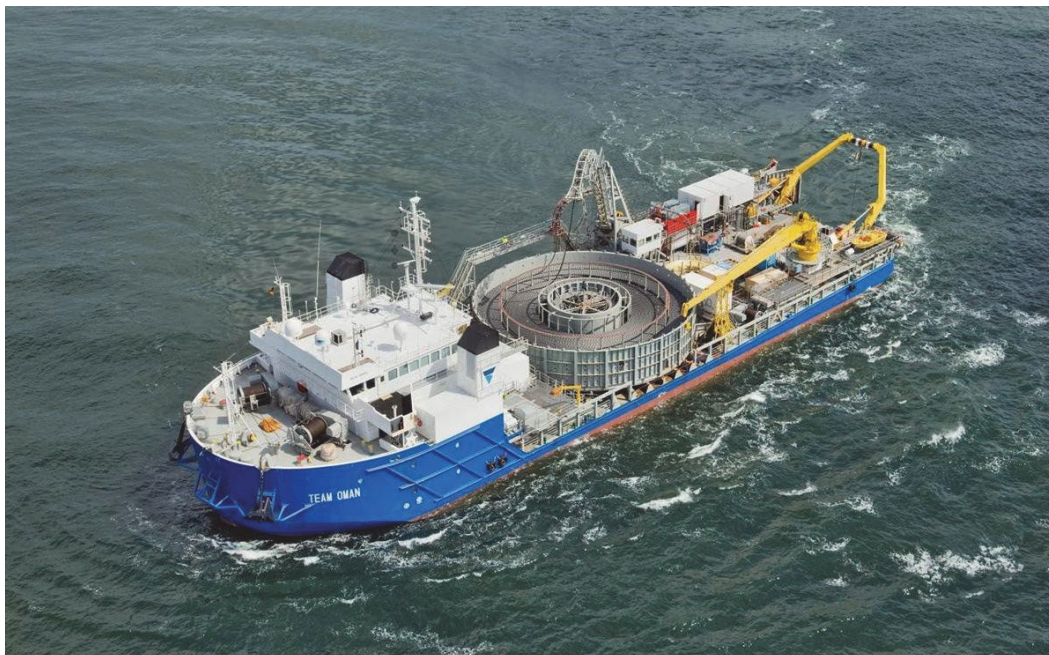
Abbildung 28: Kabelleger Topaz Installer (Quelle: VSMC).
