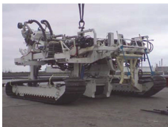
Abbildung(en) 30: Unterwasser-Eingrabegeräte (TROV) (Quelle: CTC).
