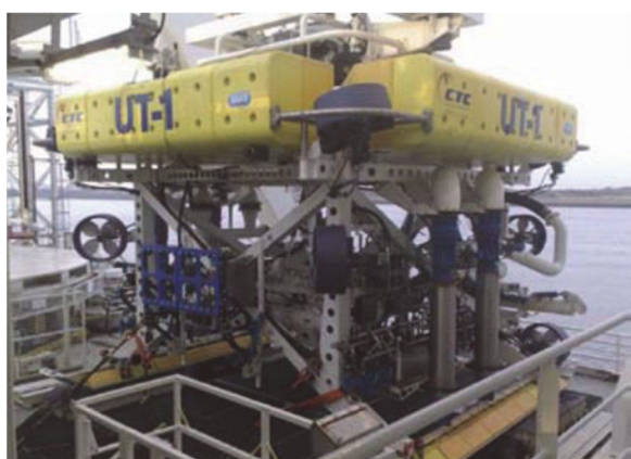
Abbildung(en) 30: Unterwasser-Eingrabegeräte (TROV) (Quelle: CTC).
