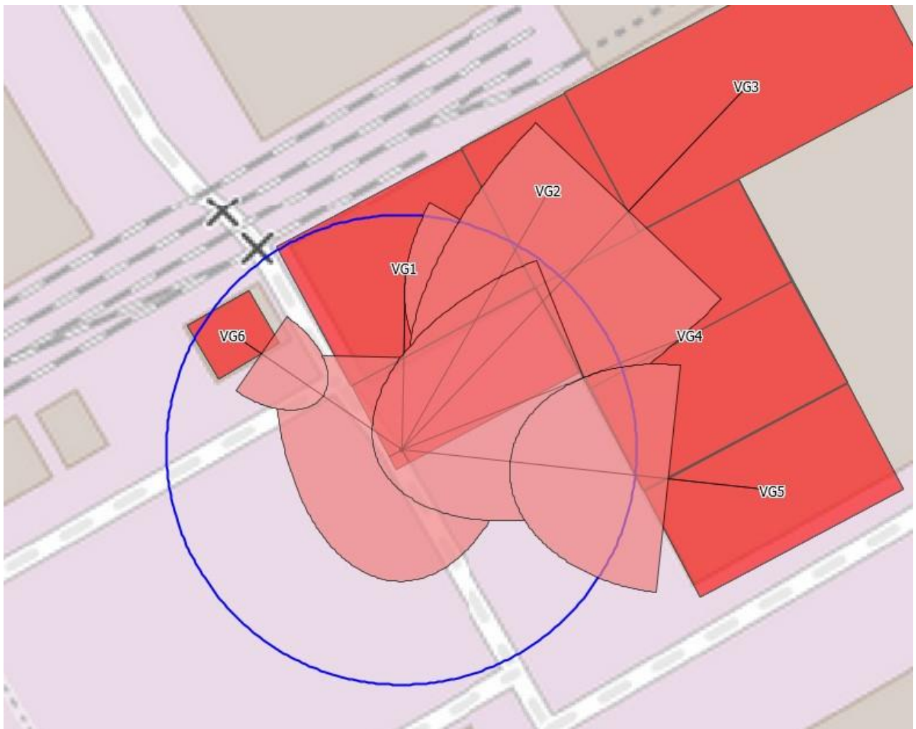
Abbildung 10: Darstellung des über WinSTACC [8] ermittelten Einwirkungskreises und den RZ der umliegenden Bebauung in 2D
