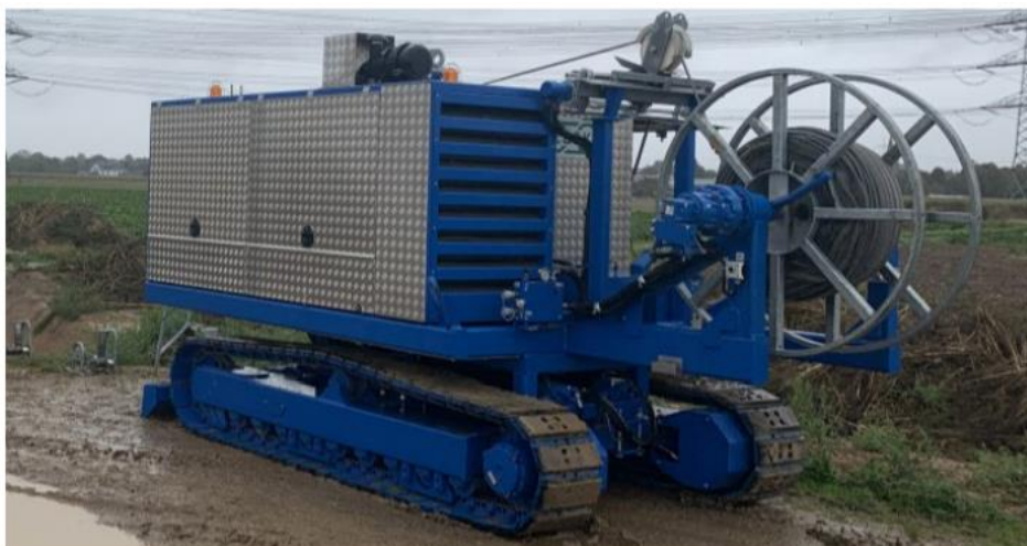
Abbildung 16: Beispiel für ein Kabelzuggerät auf selbstfahrendem Raupenfahrwerk, Quelle: Amprion GmbH
