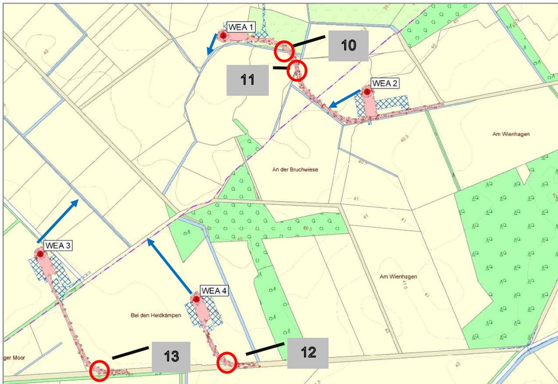
**Abb. 34** Lage der notwendigen Grabenquerungen (rote Kreise) und der Einleitstellen für die Grundwasserhaltung (blaue Pfeile) (Nummerierung gemäß „Anlage zum wasserrechtlichen Antrag – Übersichtsplan“, Quelle: Agrowea)
