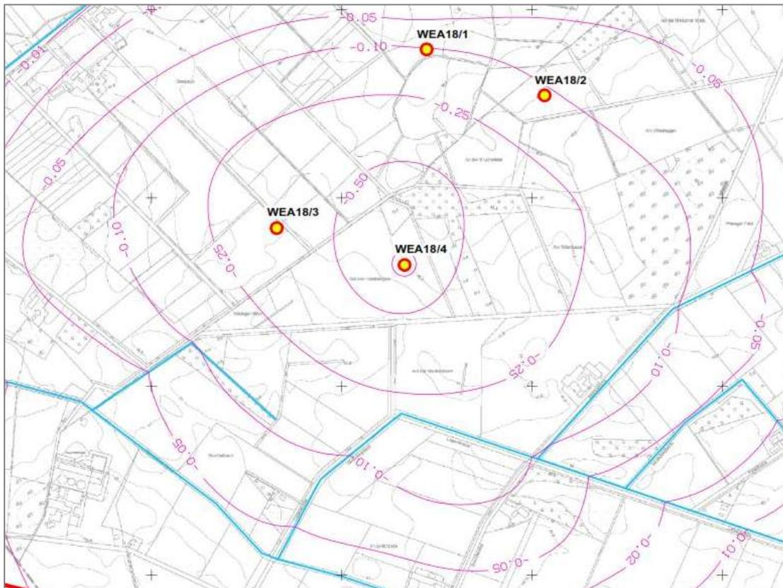
**Abb. 33 Grundwassermodell bei bauzeitlicher Wasserhaltung der WEA 4, ohne Maßstab (Quelle gemäß BGU, 2019)**
