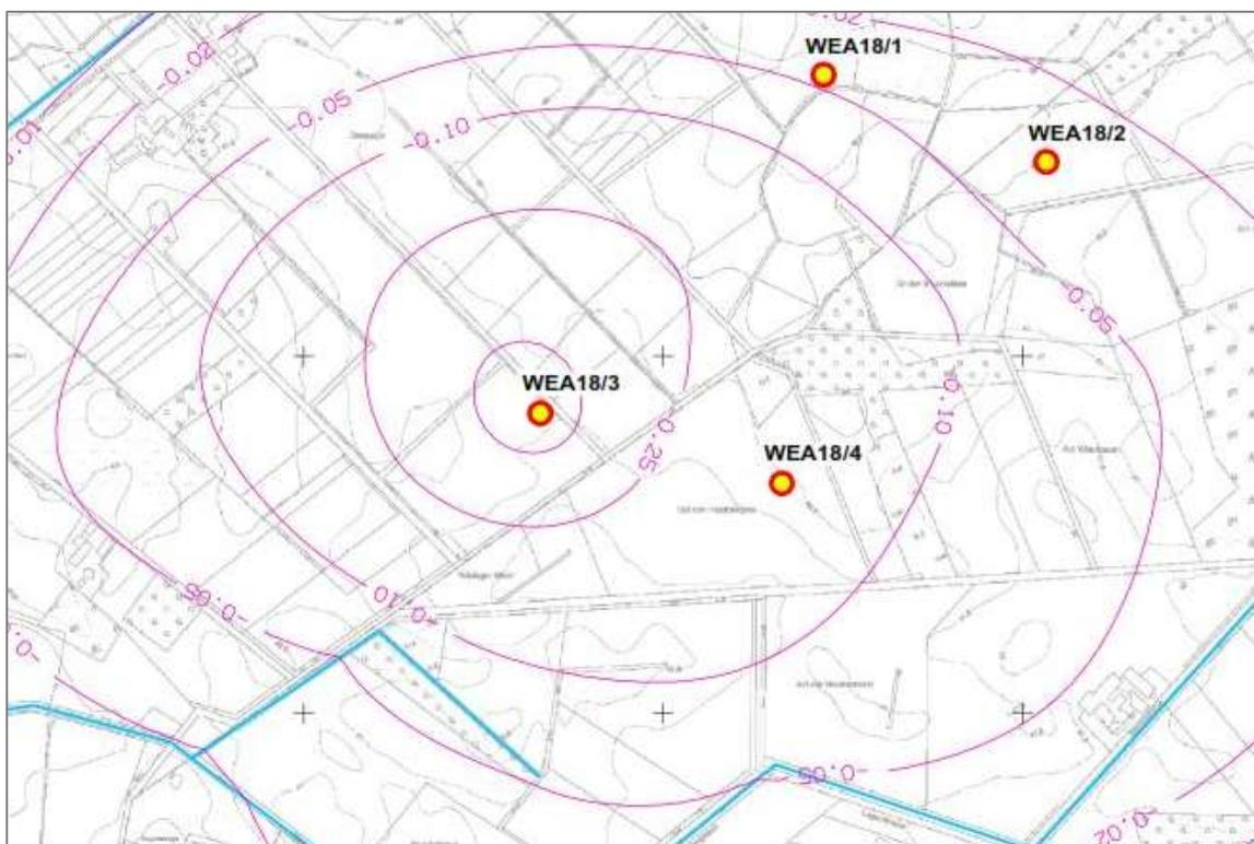
Abb. 32 Grundwassermodell bei bauzeitlicher Wasserhaltung der WEA 3, ohne Maßstab
