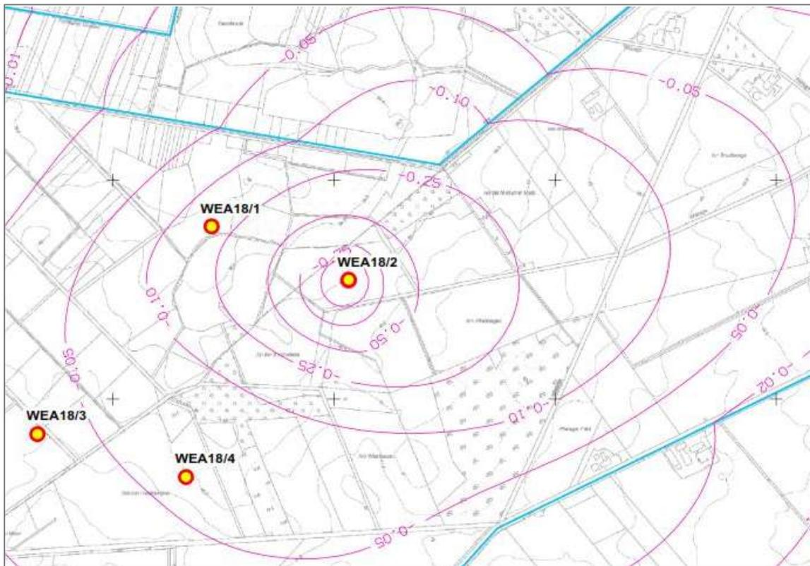
Abb. 31 Grundwassermodell bei bauzeitlicher Wasserhaltung der WEA 2, ohne Maßstab
