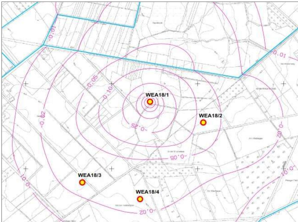
Abb. 30 Grundwassermodell bei bauzeitlicher Wasserhaltung der WEA 1, ohne Maßstab
