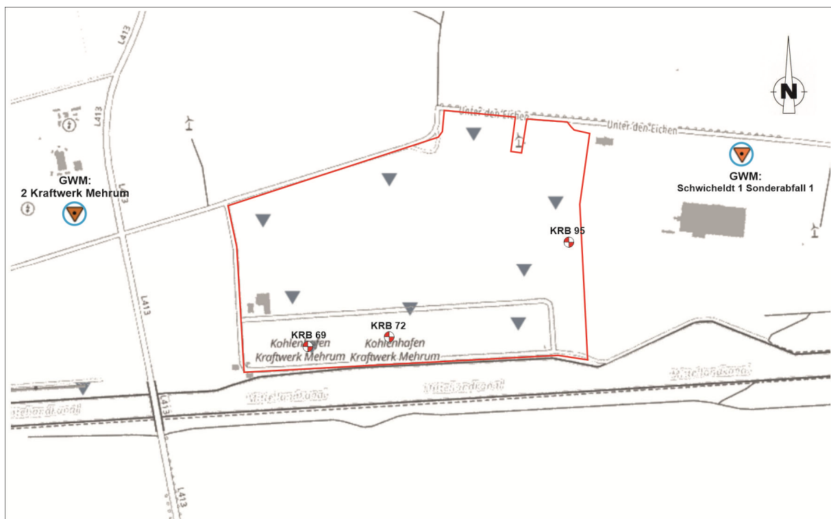
Abb. 1: Baugrundbohrungen mit Wasserführung auf dem Anlagengrundstück (rot-weißer Kreis) und Grundwassermessstellen im Umfeld des Grundstücks (oranges Dreieck hellblau eingekreist)
