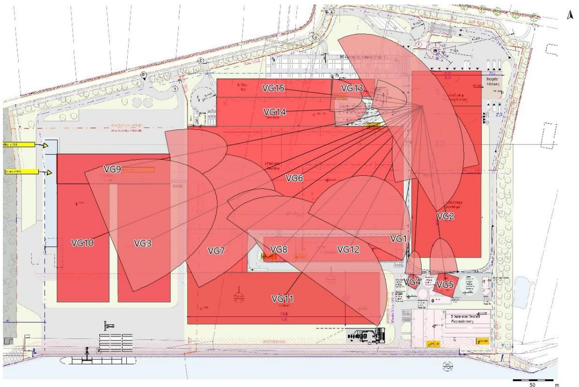
Abbildung 24. Draufsicht berücksichtigte Gebäude (WinSTACC [9]) mit Darstellung der Rezirkulationszonen für den Kamin der Gärrestetrocknung. Kartengrundlage [10].
