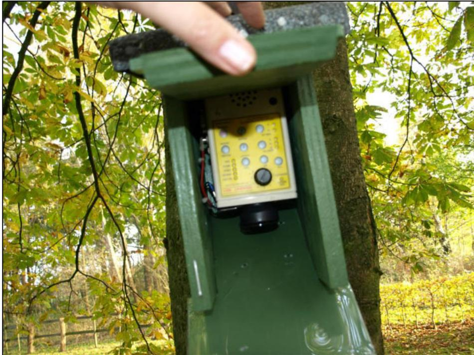
Abbildung 3: Umgebauter Fledermauskasten mit Anabat als Dauererfassungsgerät
