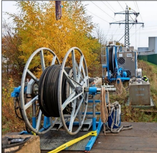
Abb. 6: Seilwinde mit Seiltrommel (OMEXOM 2022)
