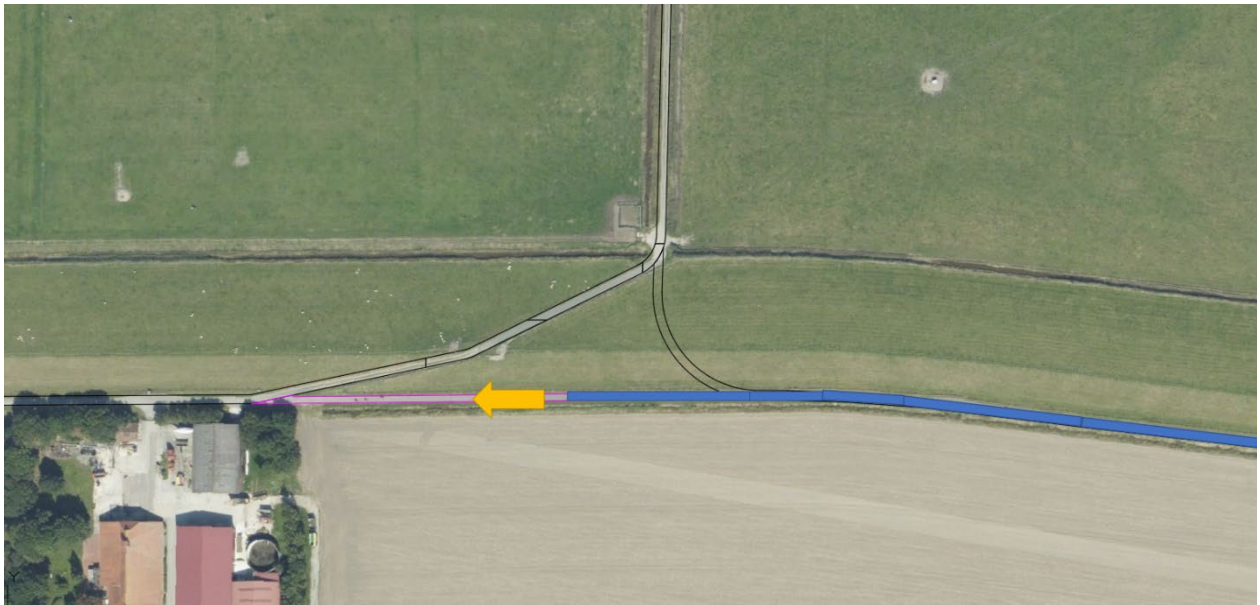
Abbildung 1: Kabelschutzrohr (blau) wird über den Weg in Richtung Westen gezogen.
