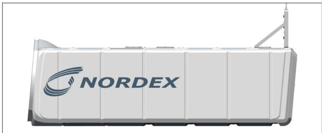
Abb. 5: Seitenansicht Maschinenhaus mit kleinteiligen Seitenteilen
