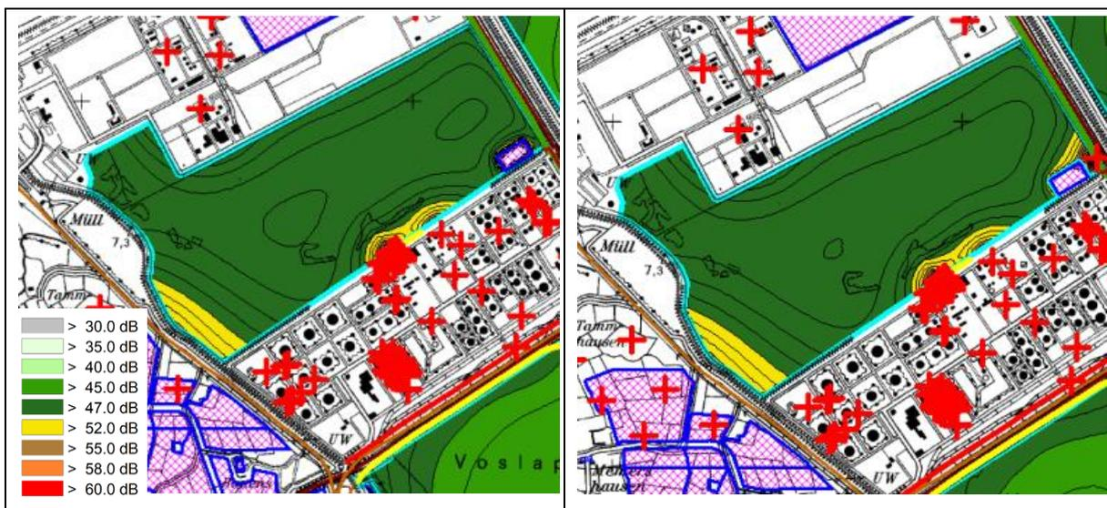
**Abbildung 6-1: Schallbelastung tagsüber im EU-Vogelschutzgebiet „Voslapper Groden Nord“ im Ausgangszustand (Vorbelastung, links) und während der vorhabenbedingten Bautätigkeiten (Gesamtbelastung, rechts)**
