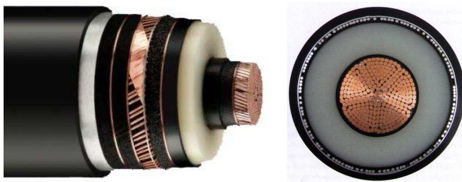
**Bild 3.4.** 380-kV-VPE-Einleiterkabel mit PE-Mantel, Kupferschirm, Aluminium-Dampfsperre, 2500 mm<sup>2</sup> Leiterquerschnitt, Außendurchmesser 14,2 cm (Quelle: Nexans)
