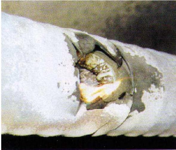
**Bild 4.8.** Zerstörung eines Kabels an der Kurzschlussstelle /2/
