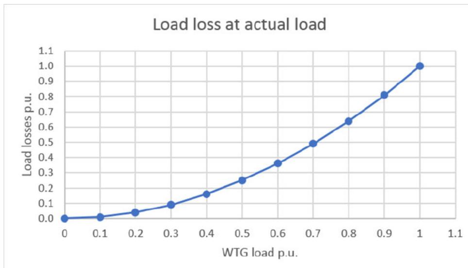
Abbildung 4-3: Transformatorlastverluste – Skalierung
