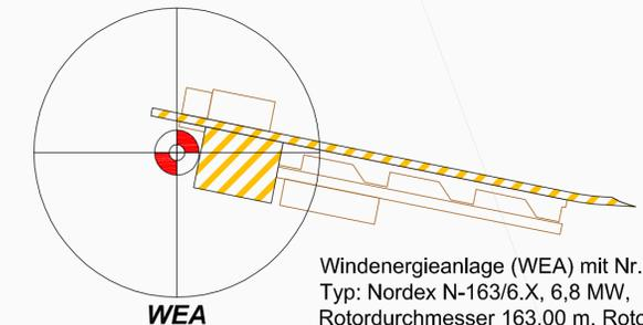
Windenergieanlage (WEA) mit Nr. Typ: Nordex N-163/6.X, 6,8 MW, Rotordurchmesser 163,00 m, Rotorradius 81,50 m, Nabenhöhe 164,00 m, Gesamthöhe 245,50 m mit Zuwegung, Stell- und Montageflächen
