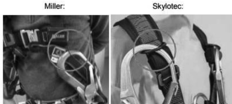
Abbildung 9-6: Befestigung der Ankerverbindung am Auffang- und Rettungsgurt
