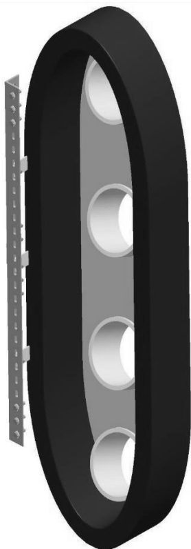
Abbildung 3-10: Mögliche Einbaulage der Hauptpotenzialausgleichsschiene
