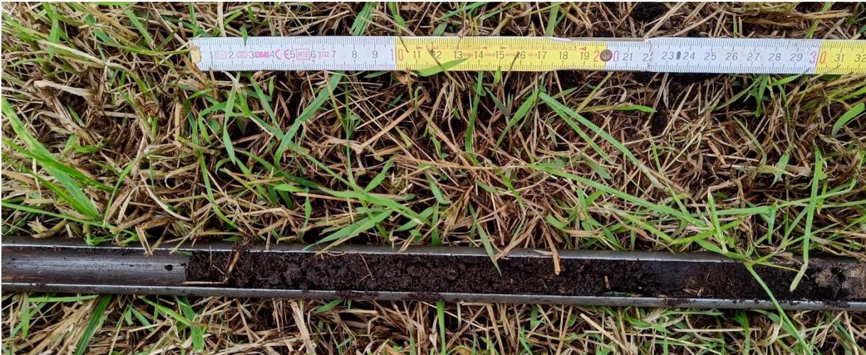
**Bild 4** Bohrstock 0 – 30 cm
