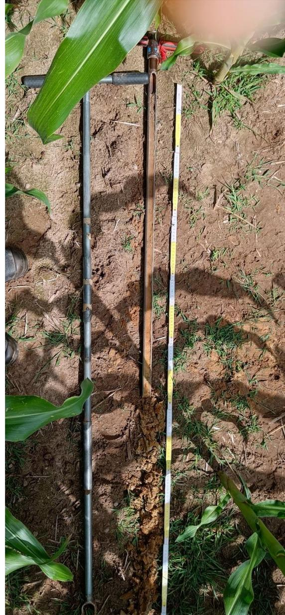
**Bild 2** Bohrung mit Pürkhauer und Edelmann-Bohrer
