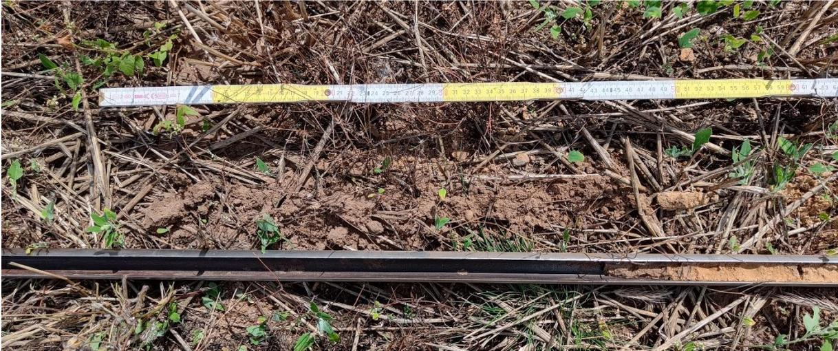
**Bild 3** Bohrstock mit Kernverlust von 0 bis ca. 45 cm
