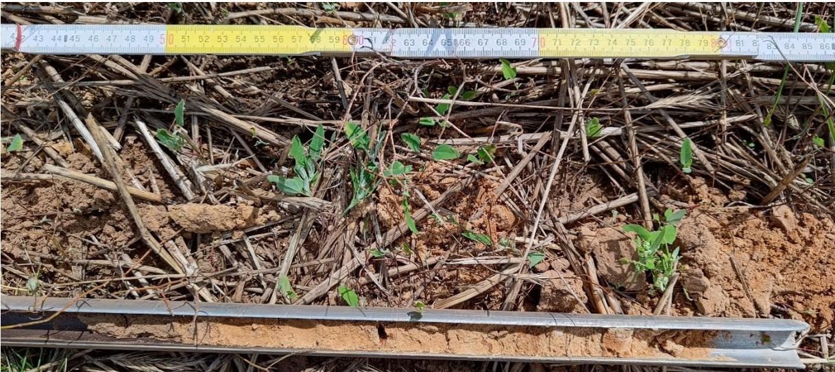
**Bild 4** Bohrstock 40 - 80 cm
