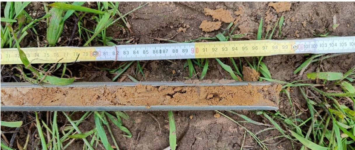
**Bild 6** Bohrstock 80 - 100 cm
