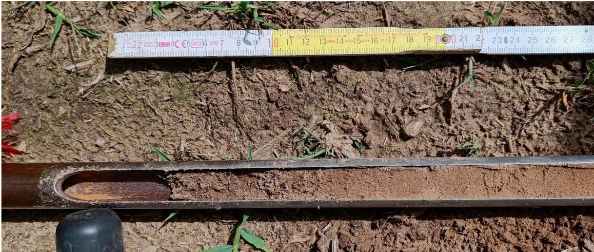
**Bild 3** Bohrstock 0 – 30 cm
