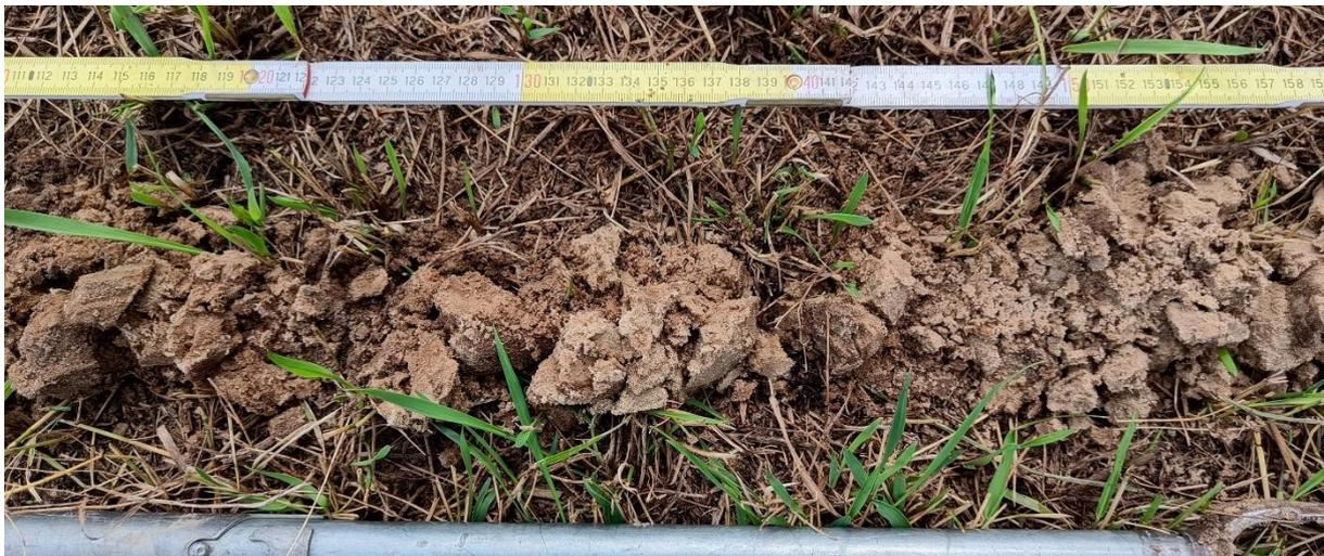
**Bild 8** Bohrgut 110 - 140 cm
