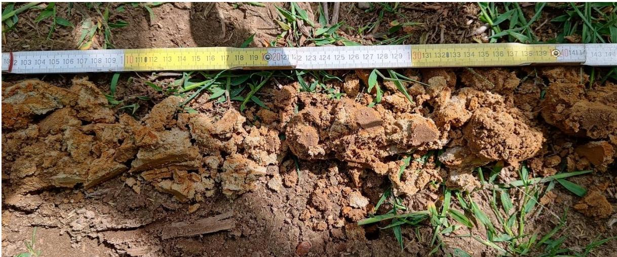
**Bild 7** Bohrgut 110 - 140 cm
