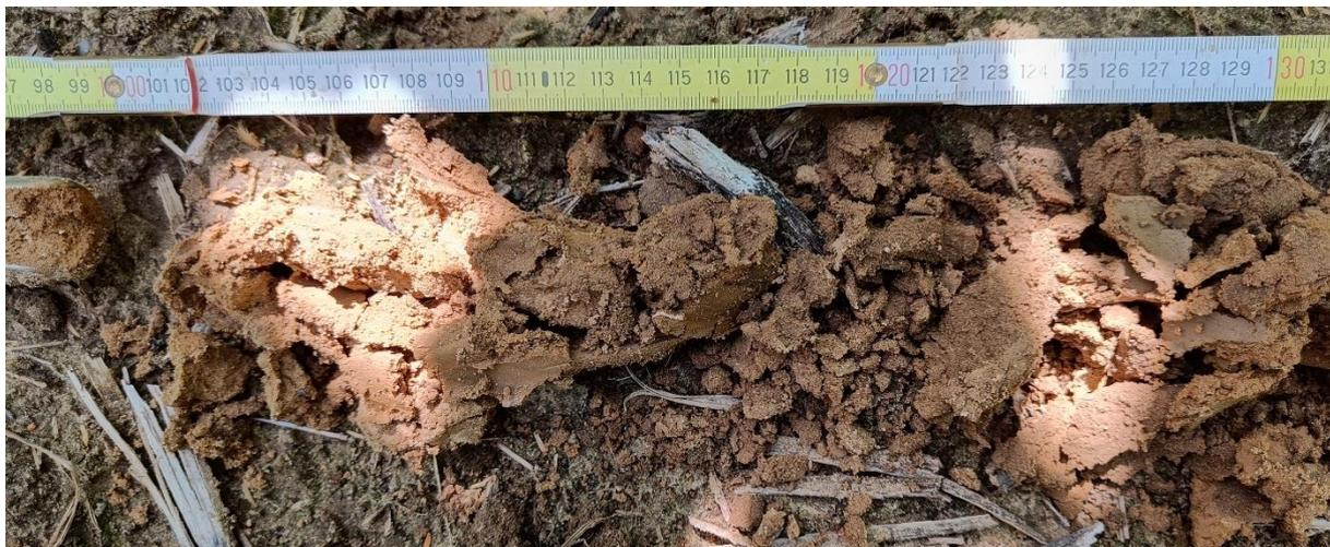
**Bild 7** Bohrgut 100 - 130 cm
