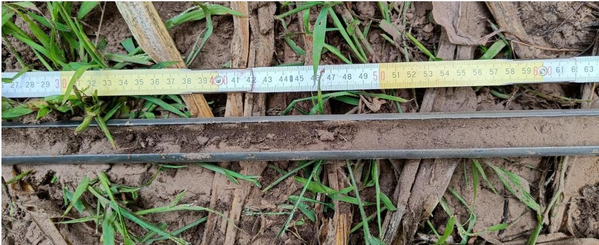
**Bild 4** Bohrstock 30 - 60 cm
