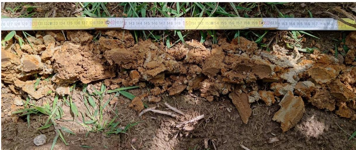
**Bild 8** Bohrgut 130 - 160 cm
