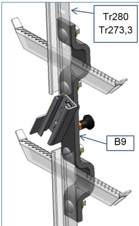
Fig. 2-18, LMB-Ausstiegsvorrichtung
