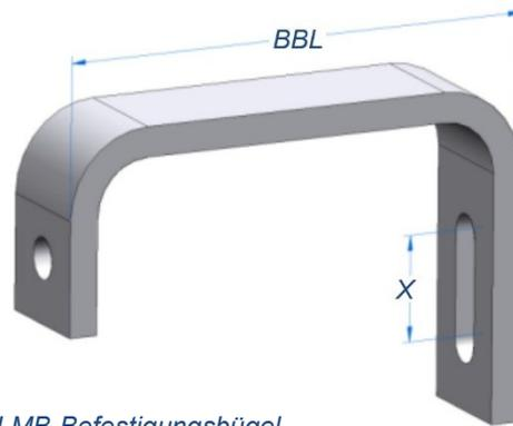
Fig. 2-16, LMB-Befestigungsbügel
