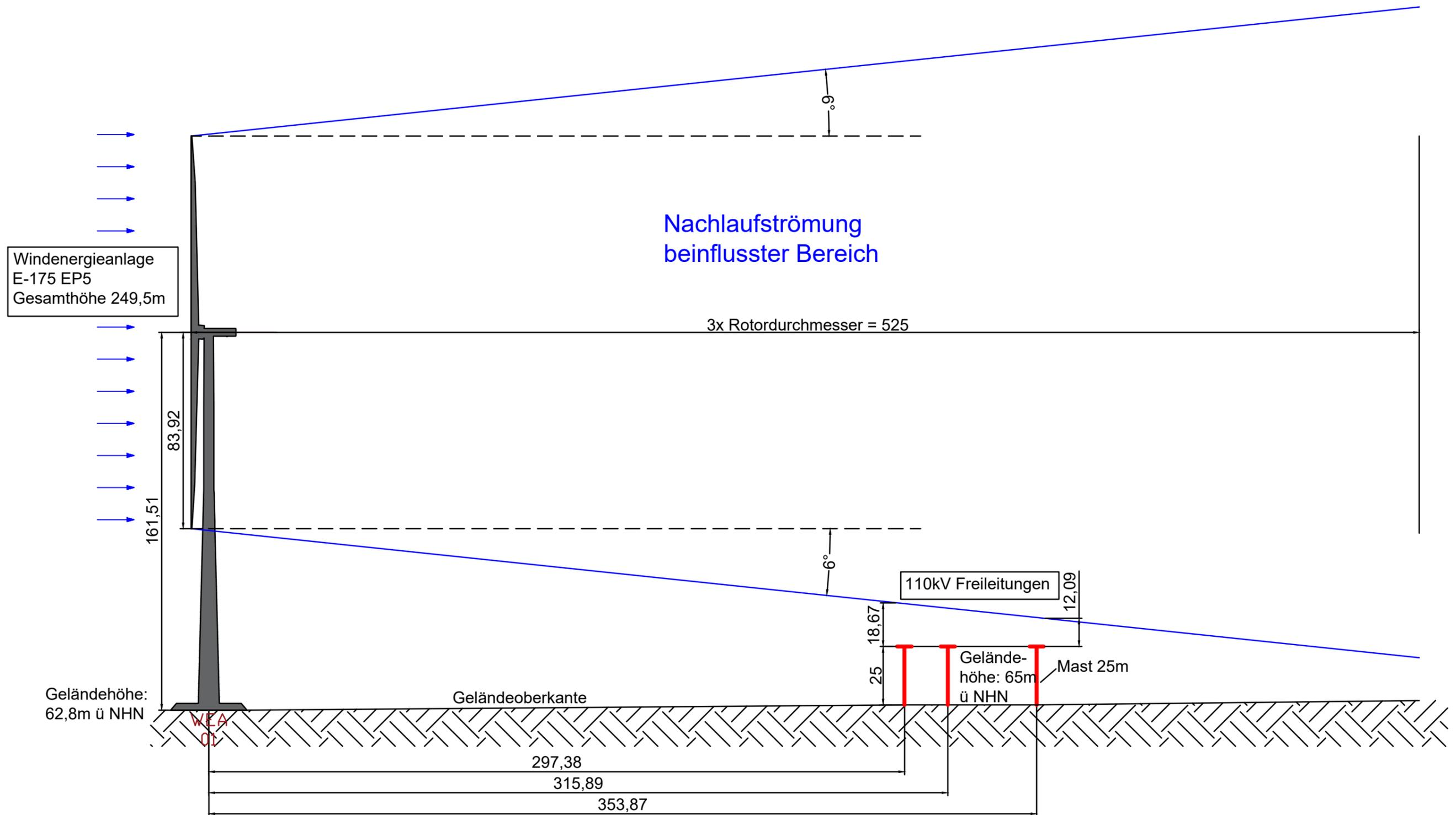
Schwingungsschutzmaßnahmen nicht erforderlich, Leiterseile der 110kV Leitungen liegen außerhalb der Nachlaufströmung
