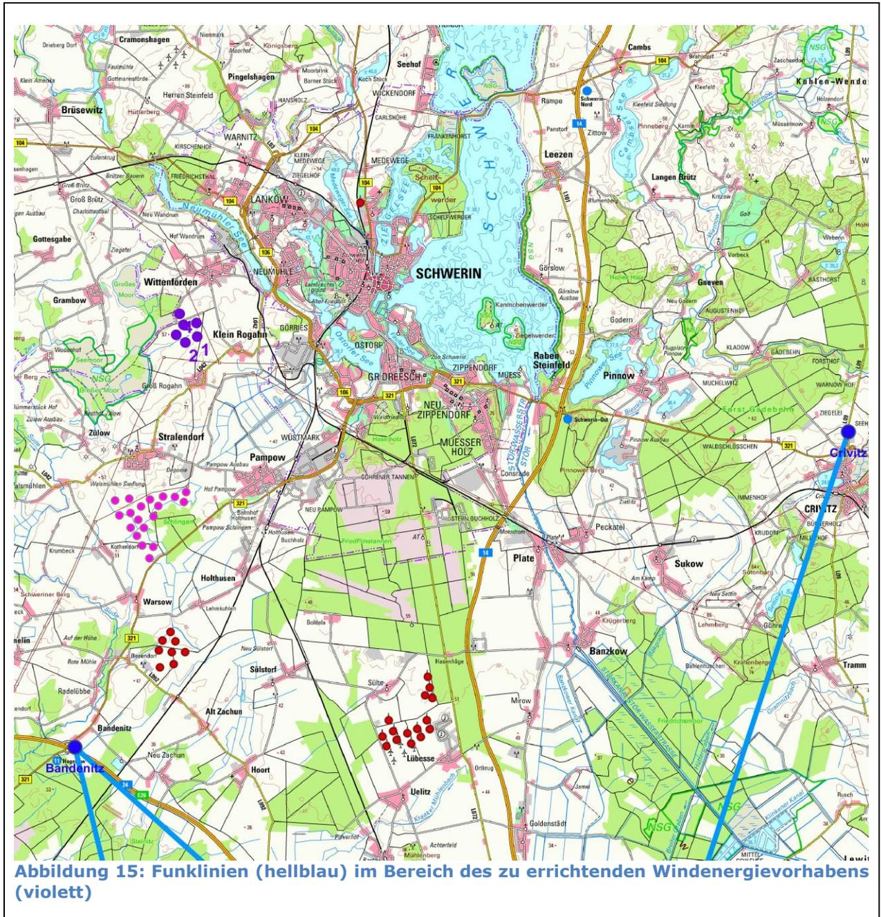
Aus obiger Abbildung ist deutlich ersichtlich, dass die bestehenden Richtfunklinien des Systems IQ FireWatch durch die Errichtung des Windenergievorhabens „Wittenförden“ keinesfalls beeinträchtigt werden. Es sind zudem keine neuen Funklinien dieses Systems im Bereich der neu zu errichtenden WEA geplant.
