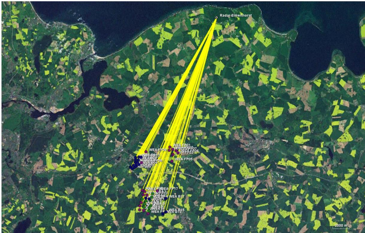
Abbildung 2: Luftaufnahme des Windparks Rehna-Torisdorf mit den geplanten Windenergieanlagen (grün), den Fremdplanungen (magenta) sowie der relevanten Vorbelastung (blau). Die Einstrahlungsrichtungen bzgl. der Radaranlage Elmenhorst sind gelb dargestellt. Um eine bessere Übersicht zu gewährleisten wurden die Bezeichnungen von einzelnen Anlagen teilweise ausgeblendet.
