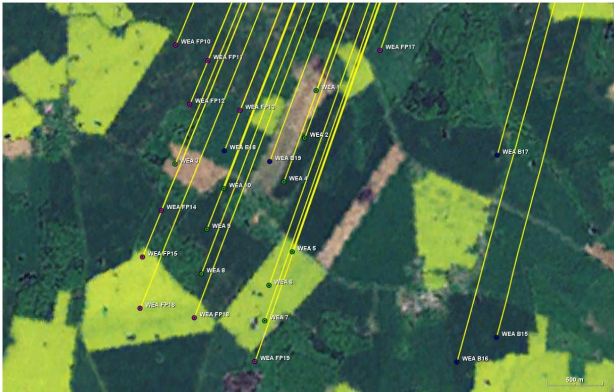
Abbildung 13: Übersicht über den Windpark Rehna-Torisdorf mit den geplanten Windenergieanlagen (grün), der Fremdplanungen (magenta) sowie der Vorbelastung (blau). Die Einstrahlungsrichtungen bzgl. der Radaranlage Elmenhorst sind gelb dargestellt.
