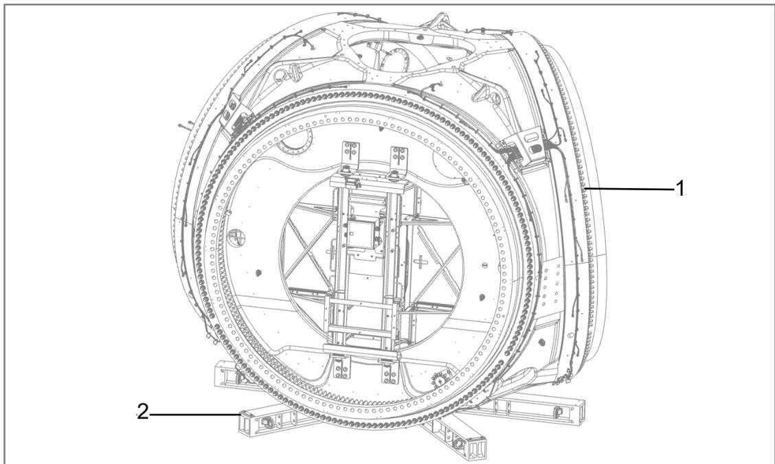
Abb. 4: Bsp. für Rotornabe (1) auf Transportgestell (2) im Transportzustand
