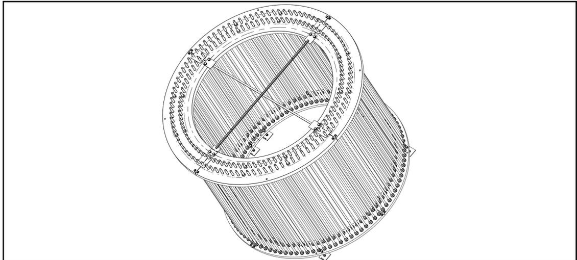
Abb. 10: Beispiel für einen Ankerkorb mit 4 x 50 Ankerbolzen
