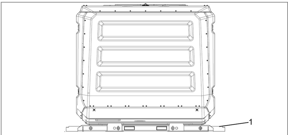
Abb. 2: Maschinenhaus, Ansicht von hinten mit Transportfüßen (1)
