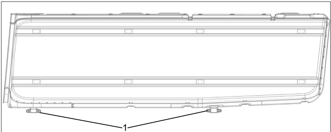
Abb. 1: Maschinenhaus, Ansicht seitlich mit Transportfüßen (1)
