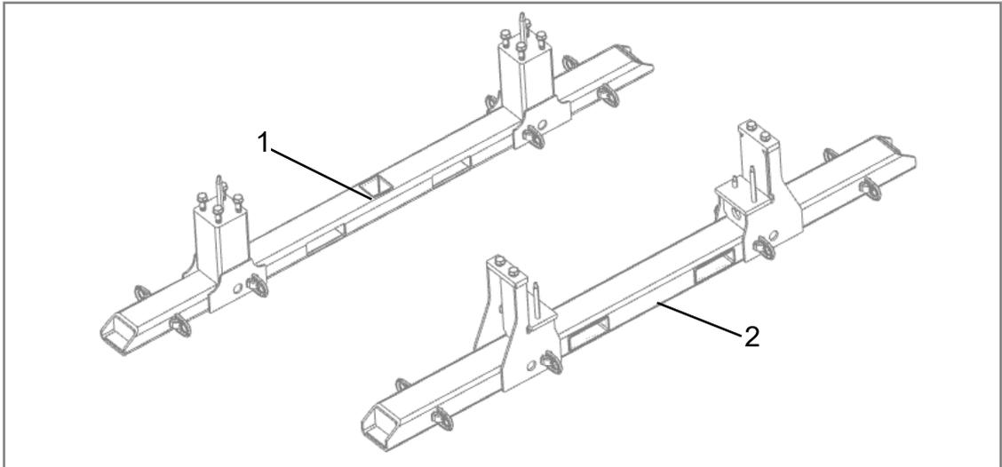
Abb. 7: Transportfüße Maschinenhaus vorn (1) und hinten (2), Abb. ähnlich
