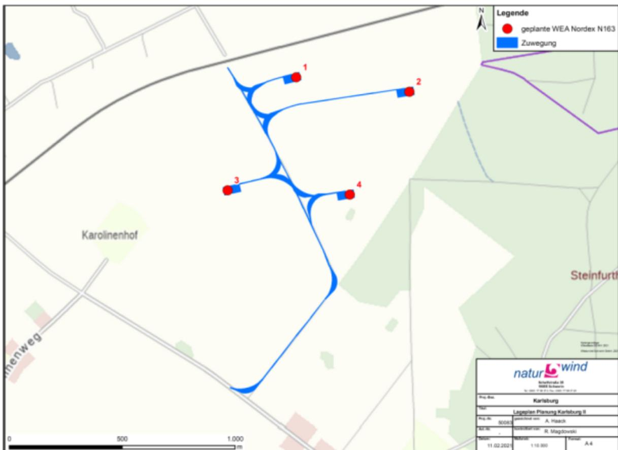
Abbildung 2: Anordnung und Zuwegung des Anlagenstandortes
