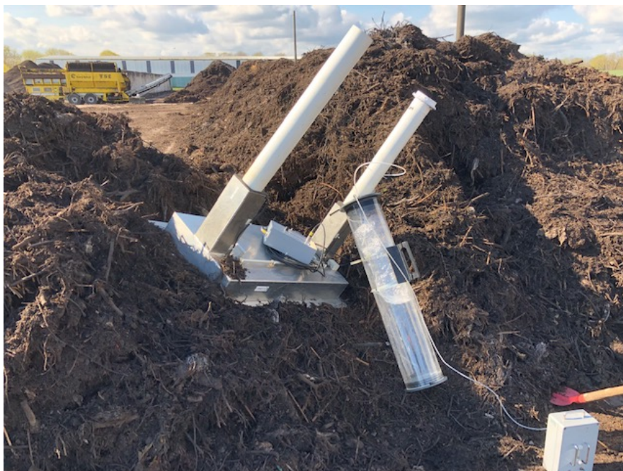
Abbildung 4: Probenahme auf einer Nachrotte, frisch umgesetzt
