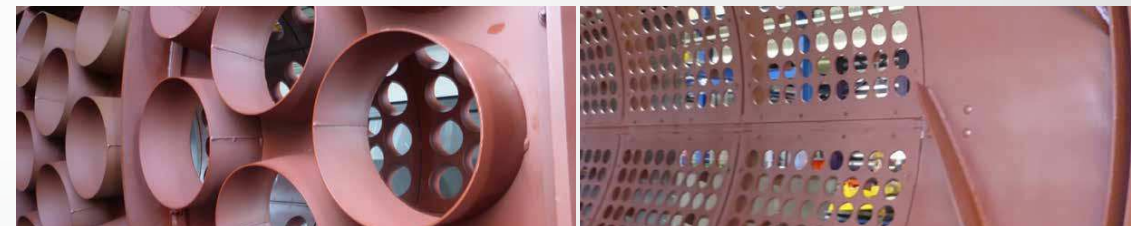
Wickelschutz durch Rohrhülsen
