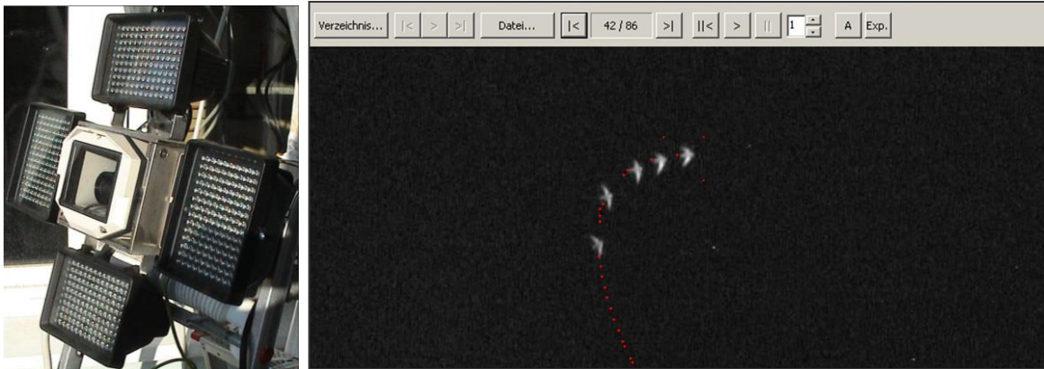
Abb. 3: Beispiel für ein Kamerasystem mit IR-Scheinwerfern (links); Serienbild eines Mauerseglers im Rotorbereich im OWP „alpha ventus“ (vgl. SCHULZ et al. 2014)
