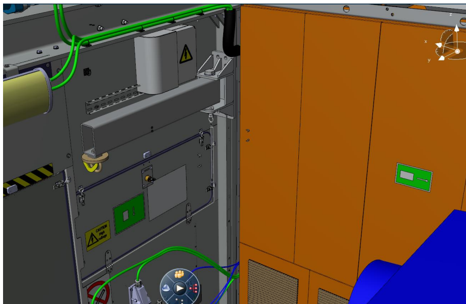
Abbildung 9: Verankerungspunkt für die Notabseilvorrichtung in der Gondel
