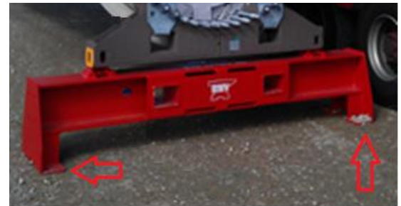
Abbildung 24: Beispiel einer Komponentenabstützung. Die Pfeile zeigen den Druckbereich (Aufstandsfläche)
