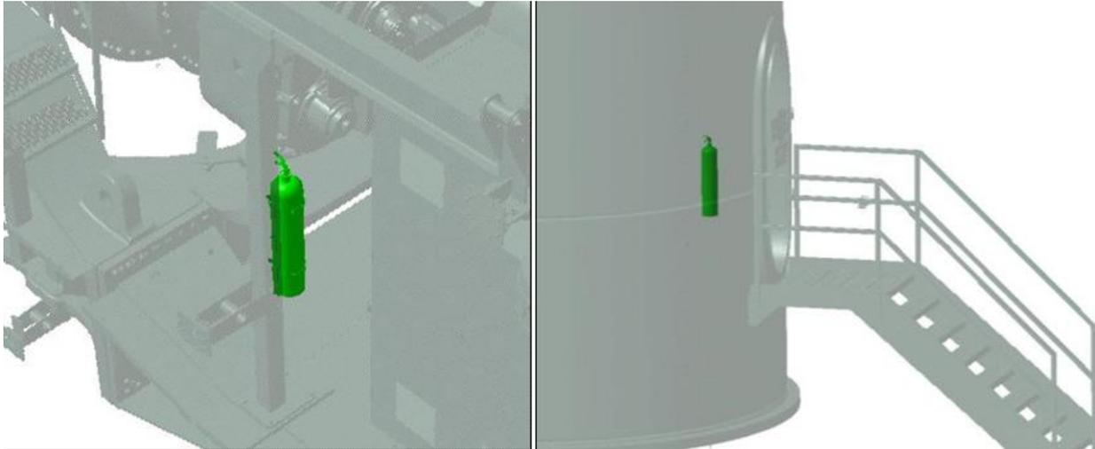
**Abbildung 7: Feuerlöscher in der Gondel (links) und im Turmfuß (rechts)**
