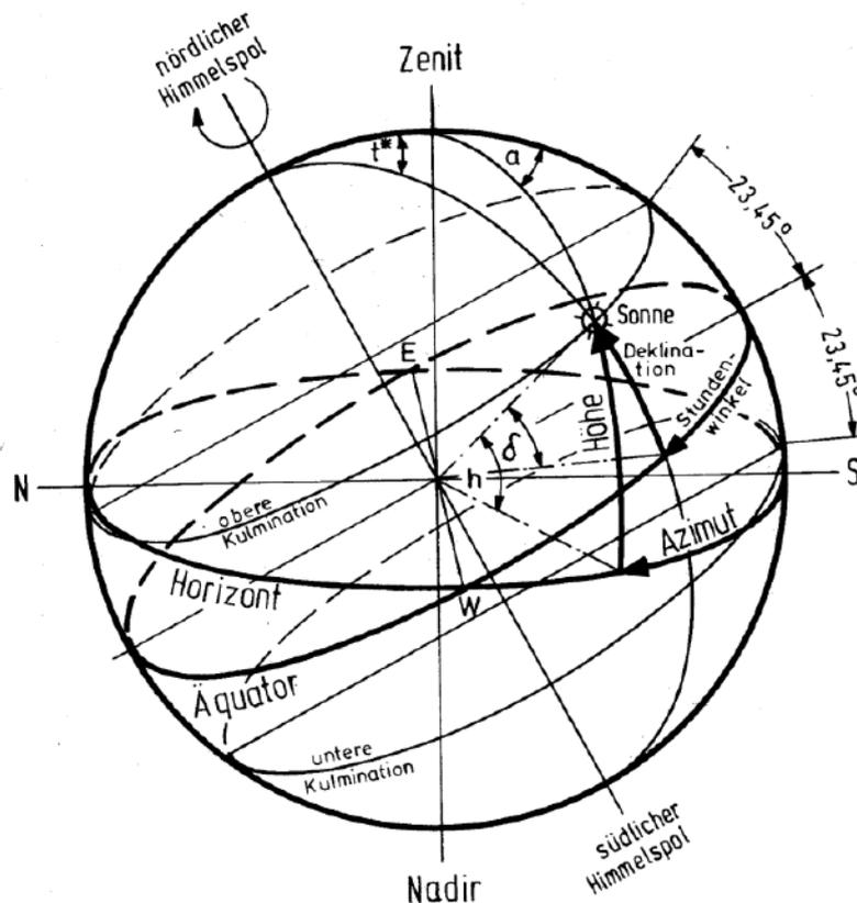
Abb. 1 Winkelzusammenhänge des Sonnenstands an einem Betrachtungspunkt
