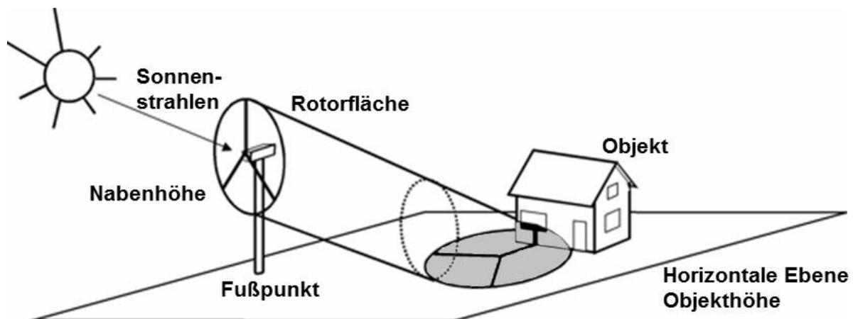
Abb. 3 Schattenwurf des Rotors
