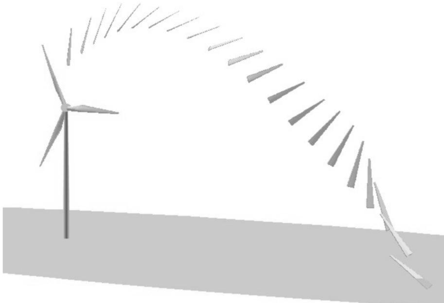
**Abbildung 2.6.1:** Beispielhafte Flugbahn eines Blattbruchstückes /1.12/.
