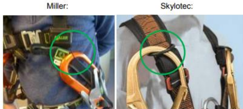
Abbildung 9-7: Befestigung der Ankerverbindung am Auffang- und Rettungsgurt
