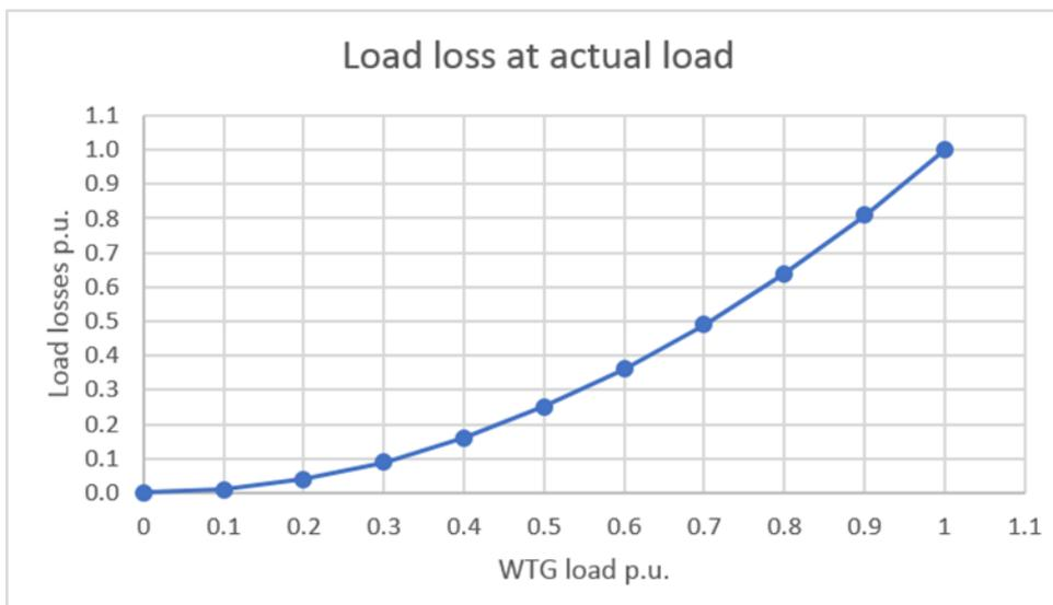
Abbildung 4-2: Transformatorlastverluste – Skalierung
