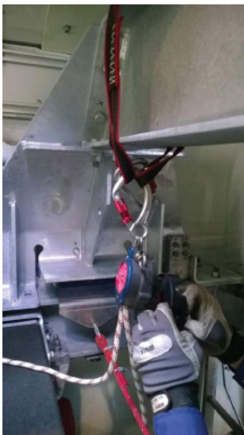
Abbildung 5.23: Am internen Ausleger befestigte Abstiegsvorrichtung
