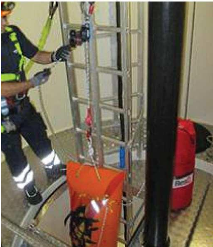
Abbildung 5.25: Absenken der verletzten Person mithilfe der Abstiegsvorrichtung
