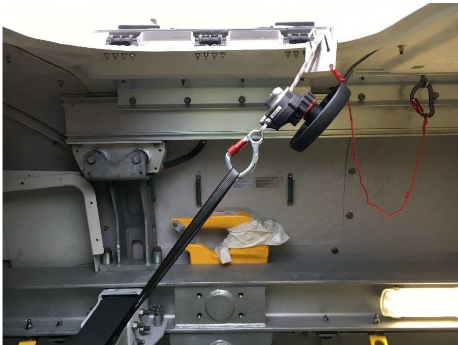
Abbildung 5.16: Abstiegsvorrichtung und Schlinge um den Querträger
