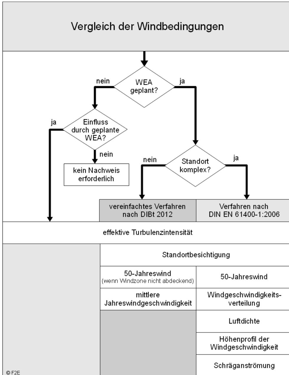
Abbildung 2.1.3: Nachweis durch Vergleich der Windbedingungen gemäß /2.8/.
