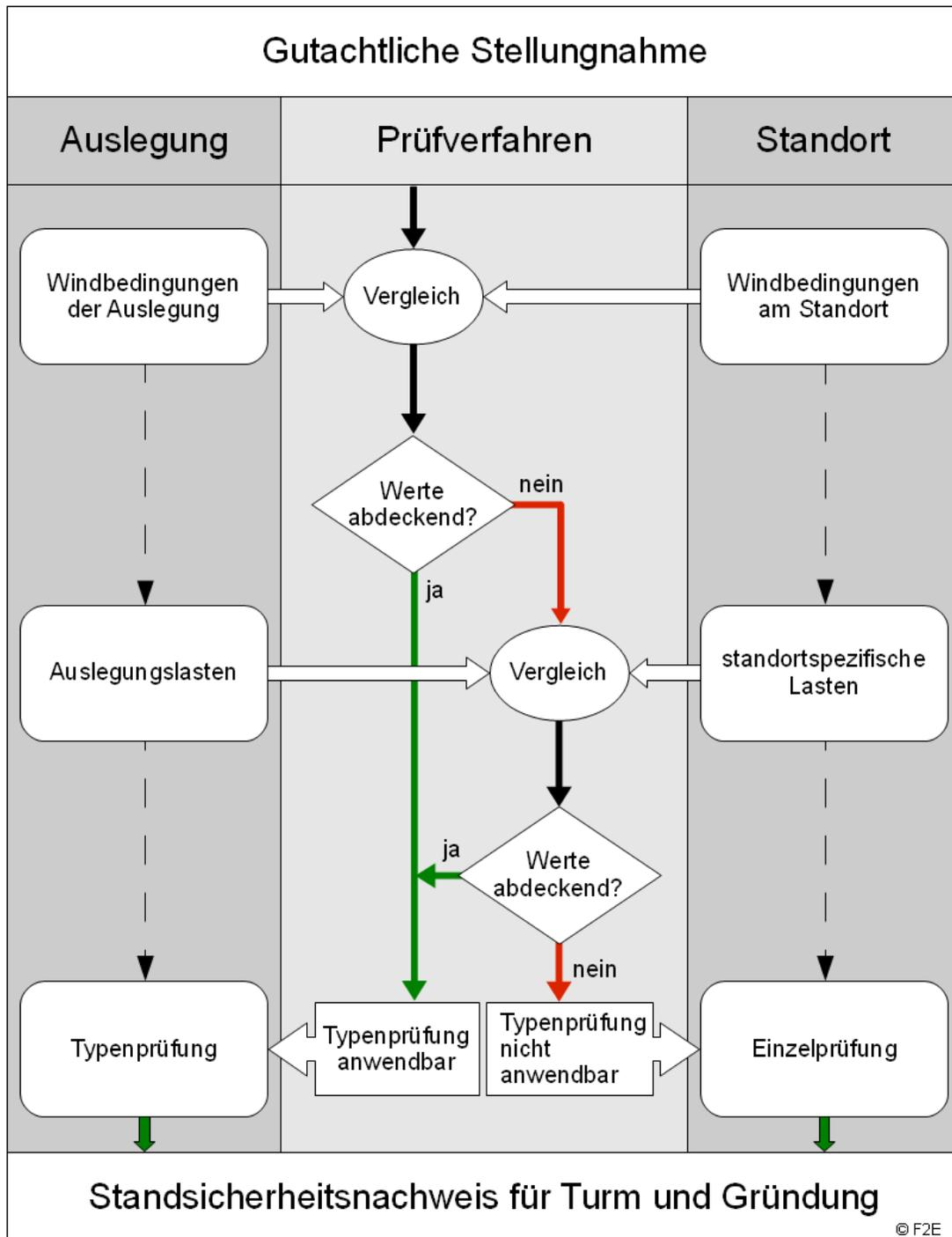
Abbildung 2.1.1: Schematische Darstellung des Prüfverfahrens.
