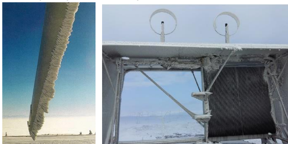
Abbildung 7-2: Ansammlung von Eis auf dem Rotorblatt und Cooler Top®
