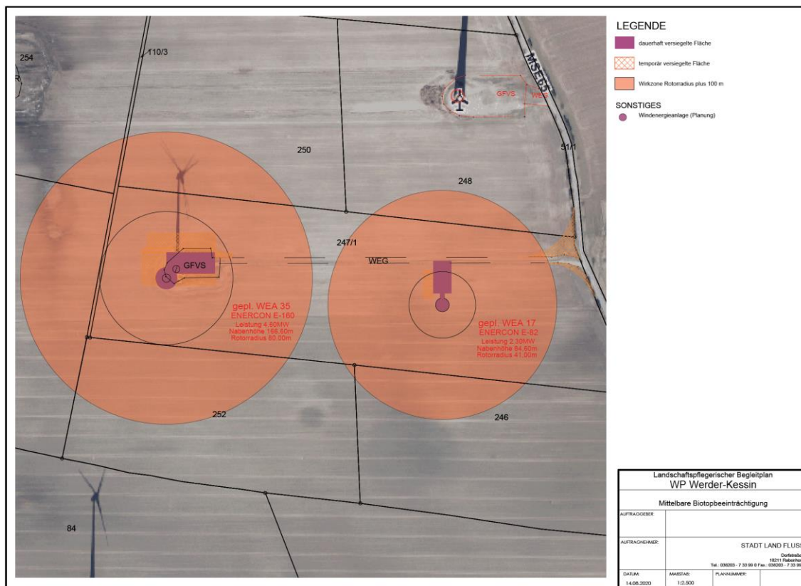
Abbildung 20: Darstellung der überstrichenen Fläche zu geschützten Biotopen, Wirkradius = Rotorradius + 100 m (orange). Anlage 9 Kartengrundlage: Umweltkartenportal MV 2020.
