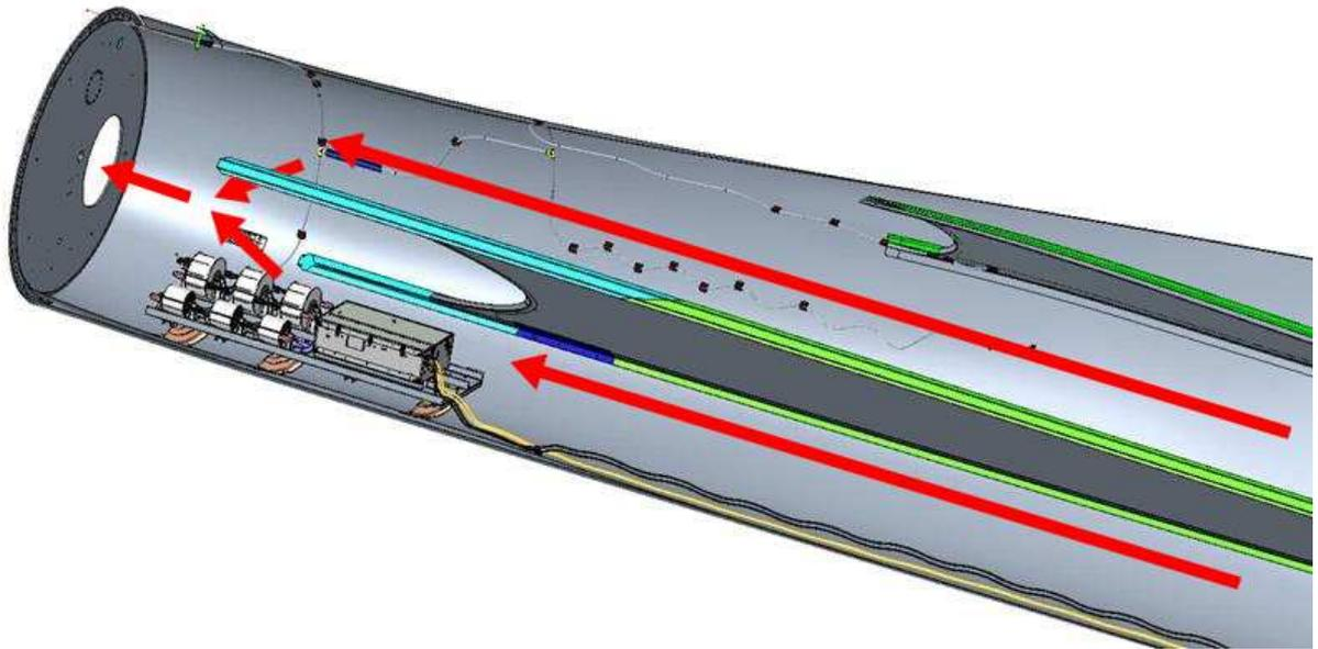
Abbildung 7.19: Evakuierungsrouten im Blatt zur Nabe (V150 VAS)
