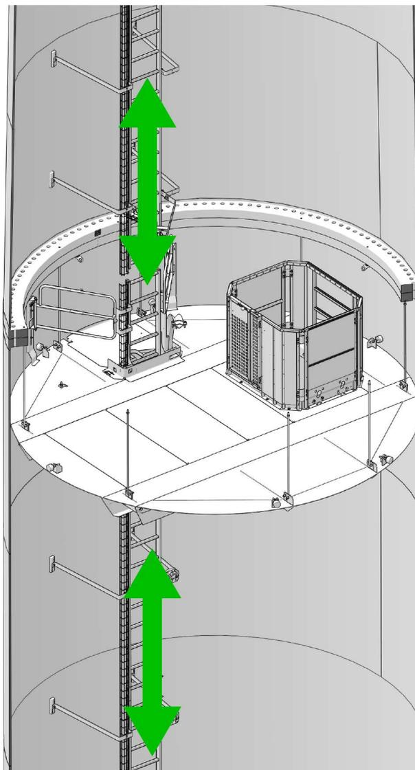
Abbildung 7.4: Übersicht über die mittlere Turmsektion
