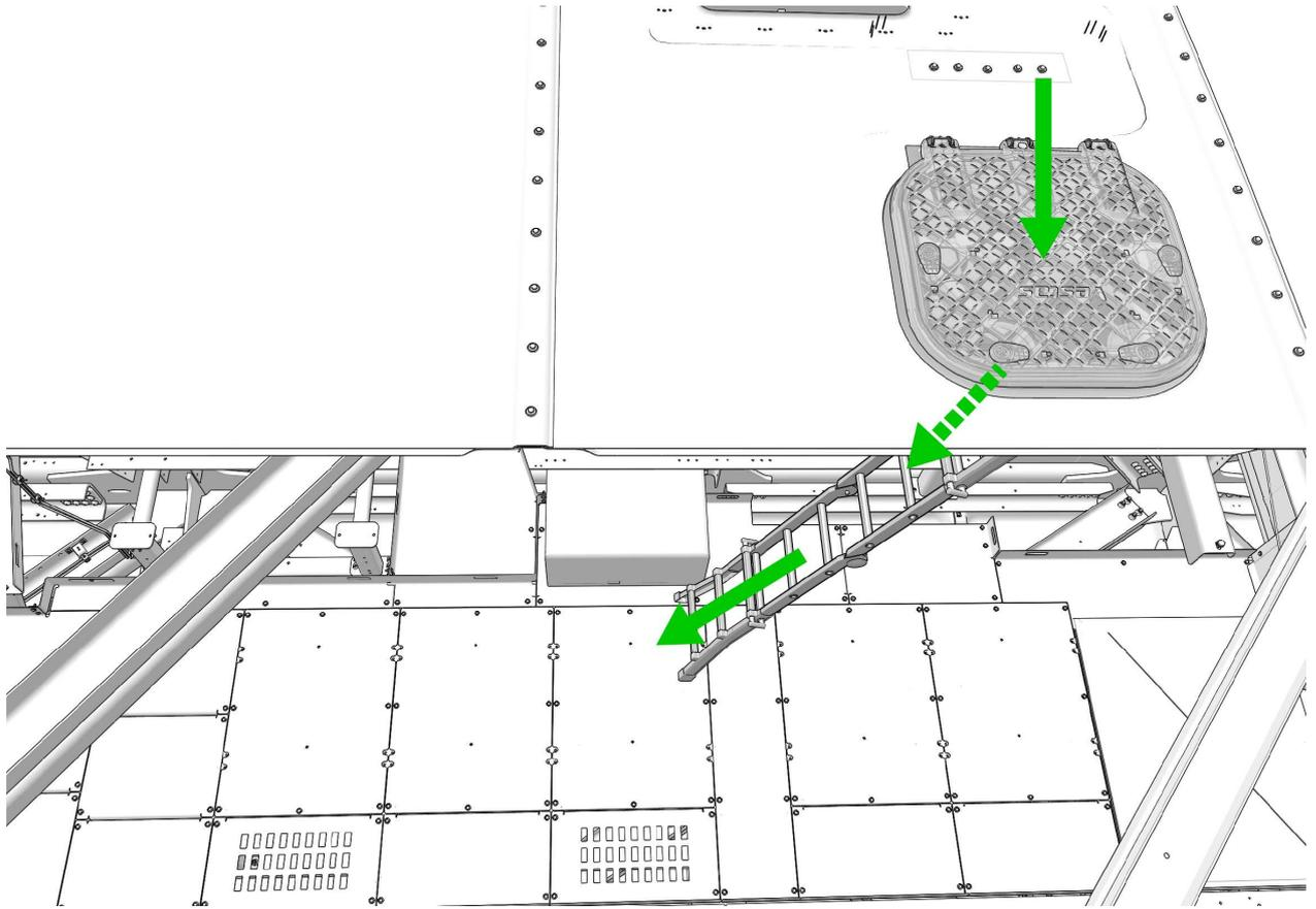
Abbildung 7.12: Evakuierungsrouten vom Maschinenhausdach durch die hintere Dachluke
