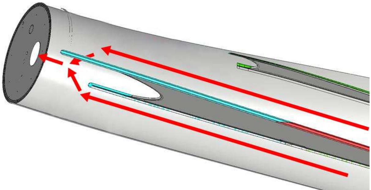
Abbildung 7.20: Evakuierungsrouten im Blatt zur Nabe (EnVentus™ V162-5.6 MW)
