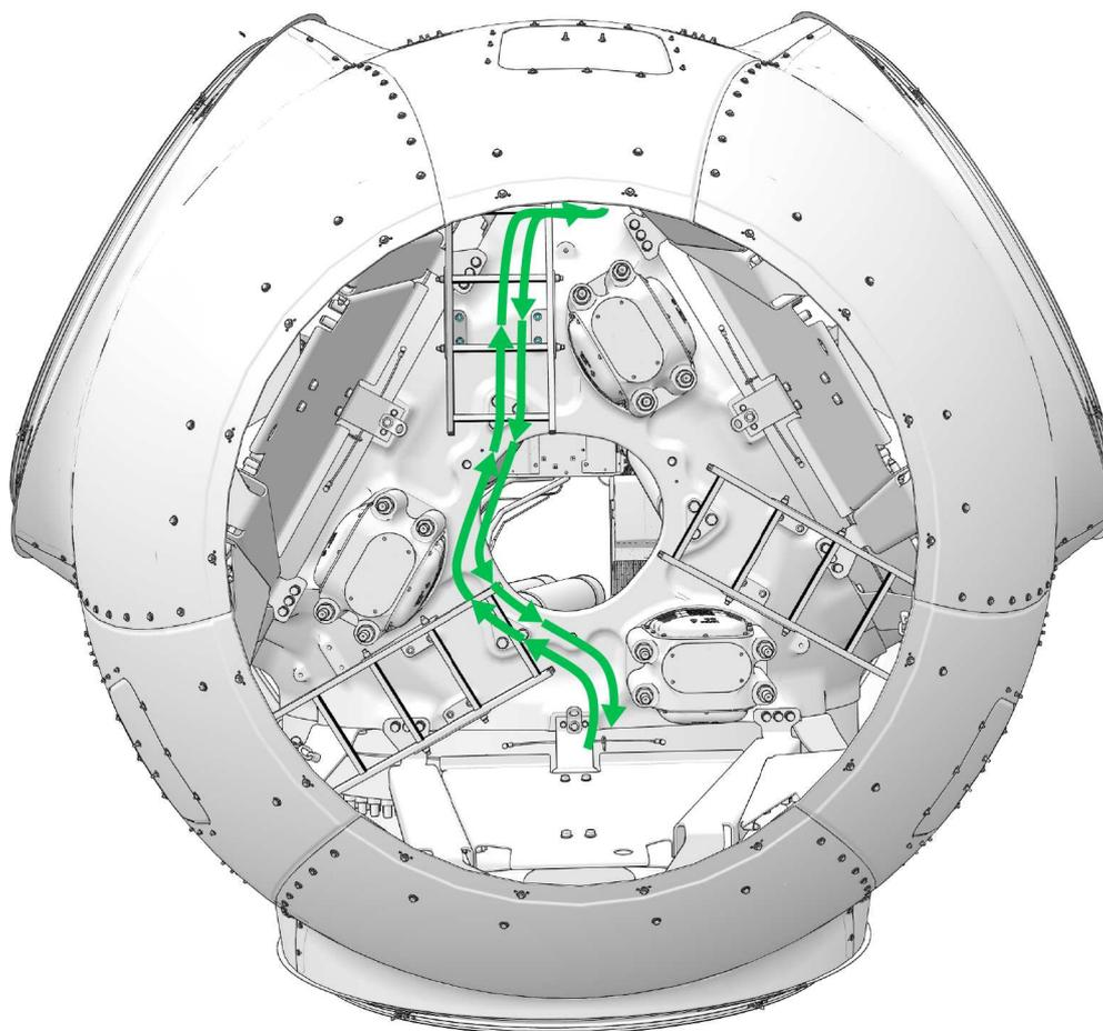
Abbildung 7.17: Zugang und Evakuierungsrouten von der Nabe
