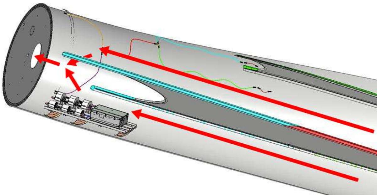
**Abbildung 7.21: Evakuierungsrouten im Blatt zur Nabe (V162 VAS)**
