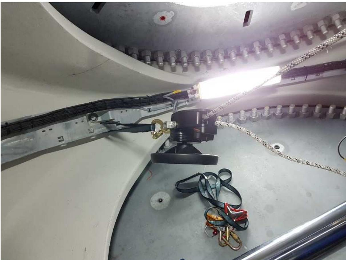
Abbildung 7.25: Befestigung des Rettungsgeräts an der Nabenthalterung
