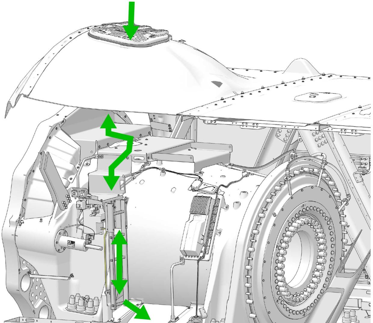
**Abbildung 7.13: Evakuierungsrouten vom Maschinenhausdach durch die vordere Dachluke**
