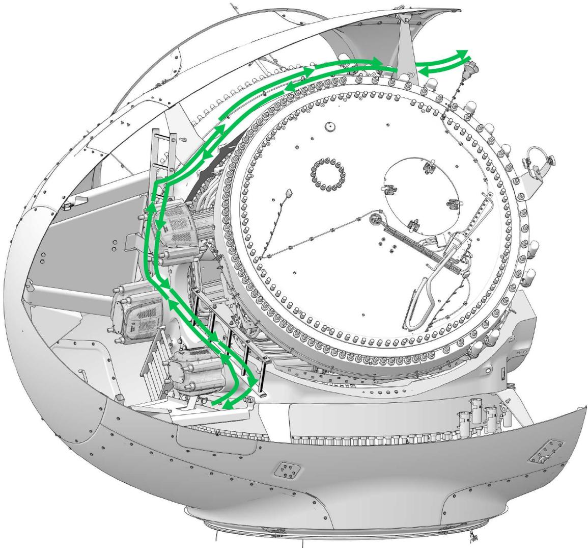
Abbildung 7.16: Zugang und Evakuierungsrouten von der Nabe
