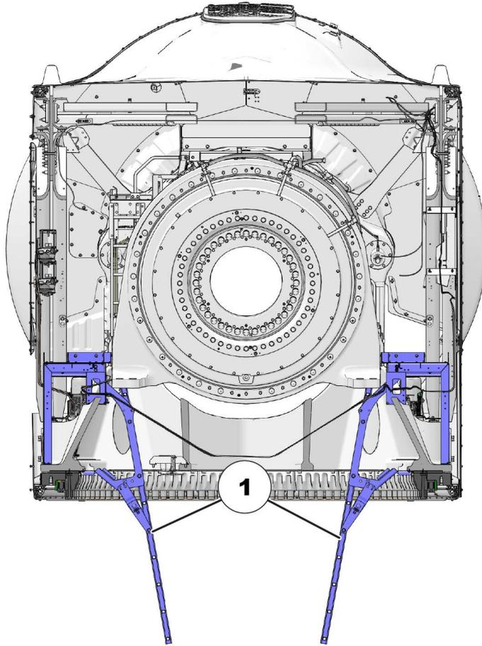
**Abbildung 7.14: Evakuierungsrouten vom Maschinenhaus über die Maschinenhausleitern**
