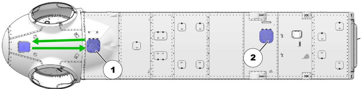
**Abbildung 7.8: Übersicht über die Zugangsrouten im Maschinenhausdach**
