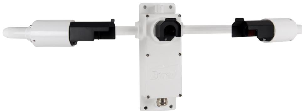
Abbildung 3-1: Sichtweitensensor (SWS 200-N-AC)
