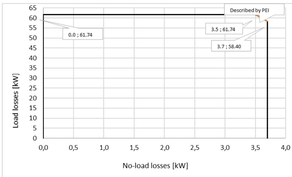
Abbildung 4-1: Transformatorverluste – zulässiger Bereich für die Variante 7000 kVA
