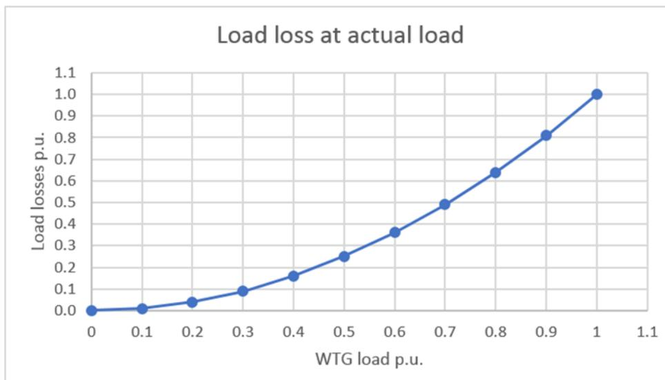
Abbildung 4-3: Transformatorlastverluste – Skalierung
