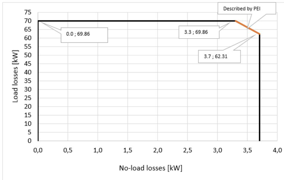
Abbildung 4-2: Transformatorverluste – zulässiger Bereich für die Variante 7300 kVA
