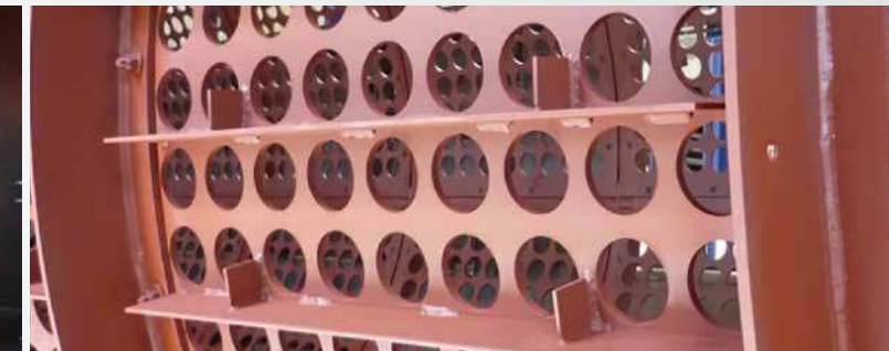
Wickelschutz durch Flachstähle
