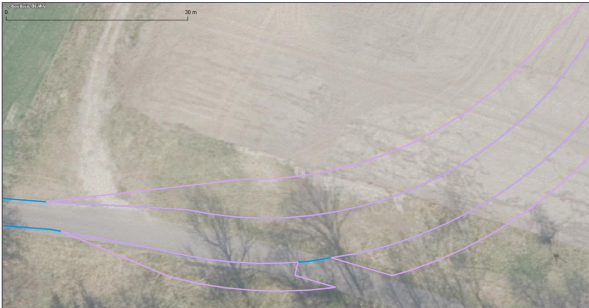
Abbildung 10: Nutzung eines bestehenden gehölzfreien Abschnitts als Zufahrt (blau; Überschwenkbereiche lila abgegrenzt) zur WEA 05 unter Vermeidung der Betroffenheit von Bäumen (Luftbild Stand 2022; Quelle: Kartenportal LUNG M-V)
