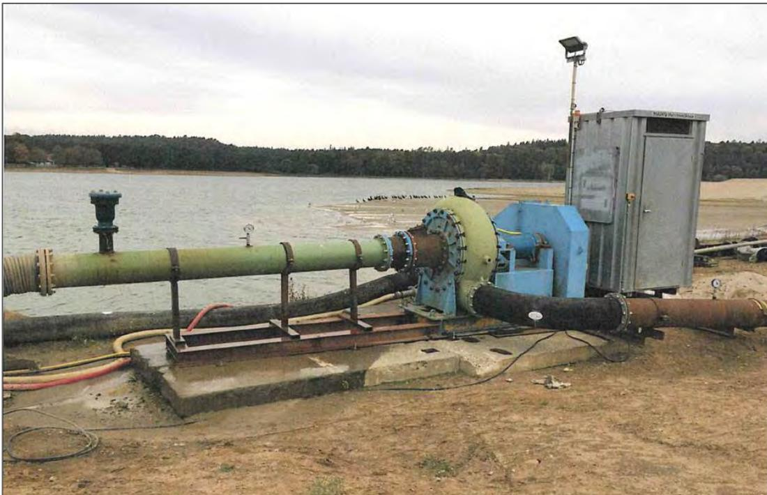
Abbildung 1: Zwischenpumpe
